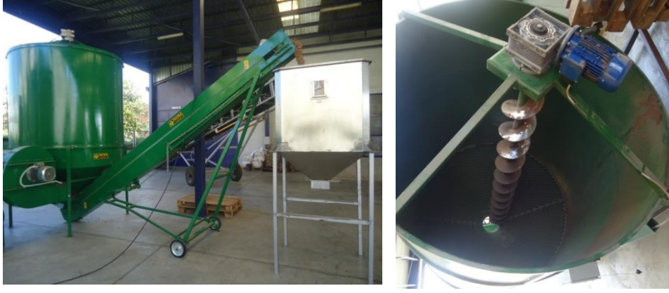
Şekil 3.4. Fındık kurutma makinesi (FACMA ES 3000, 2013)
