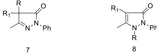
Şekil 1.3. 3-Metil- ve 3,4-dimetil-1-fenilpirazol-5-on bileşikleri -CH formu (7, R = R 1 = Me) ve -NH formu (8, R = Me , R 1 = H)
