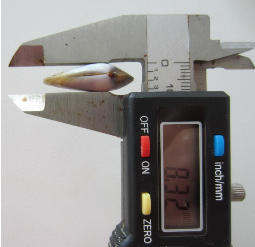
Şekil 3.11. Kabuk kalınlığı (KK) ölçülmesi
