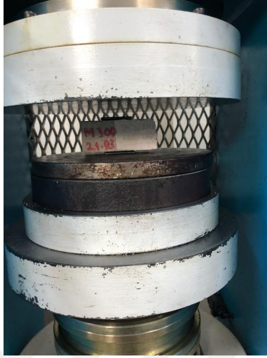
Şekil 4.21 Eğilmede çekme deneyi sonrası basınç deneyi
