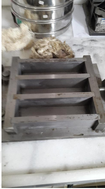
Şekil 4.12 Numune kalıpları (40 x 40 x 160 mm)
