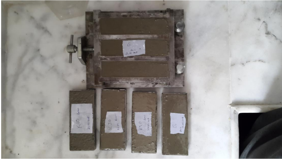
Şekil 4.14 Kalıplara yerleştirilmiş deney numuneleri
