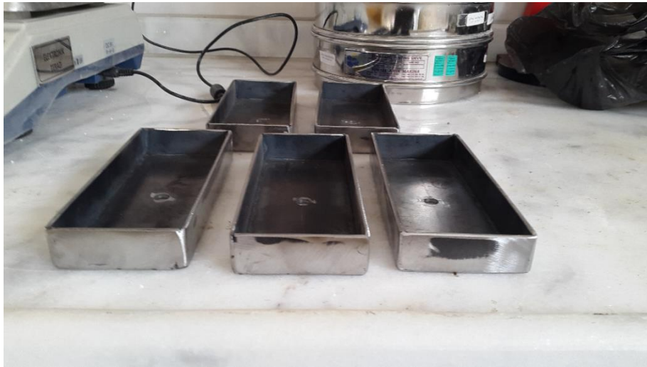
Şekil 4.11 Numune kalıpları (20 x 60 x 150 mm)
