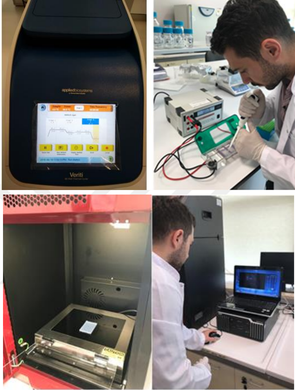
Şekil 3.13 DNA'ların PCR ile çoğaltılması, agaroz jelde (% 1.5'lük) yürütülmesi ve UV ışınları altında DNA'ların bant büyüklüklerinin görüntülenmesi
