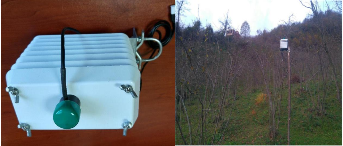
Şekil 3.2 Sıcaklık, Nem ve PAR Veri Kaydedici Cihaz ve Bahçedeki Görünümü
