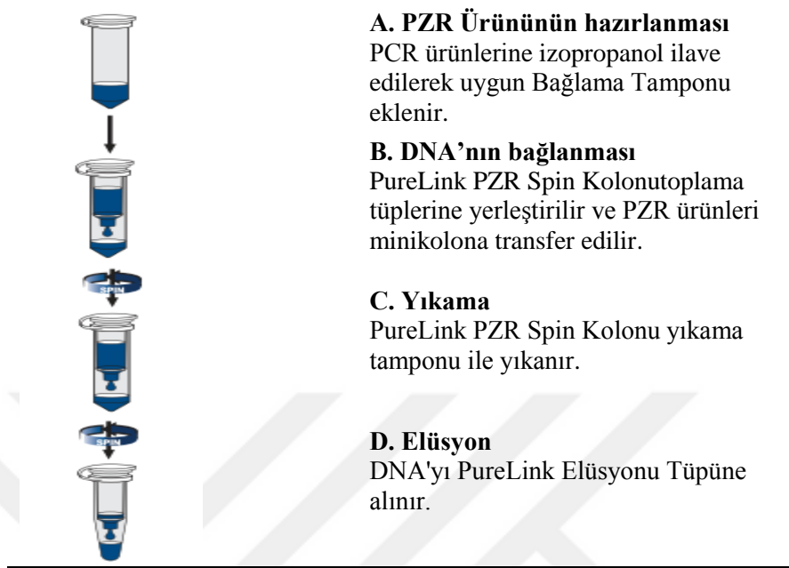
Çizelge 3.5 PZR ürünün saflaştırılması işleminin şematik gösterimi (INVITROGEN PureLink™PZR Saflaştırma Kiti (Cat.No.K310001) ürün protokolünden alınmıştır
