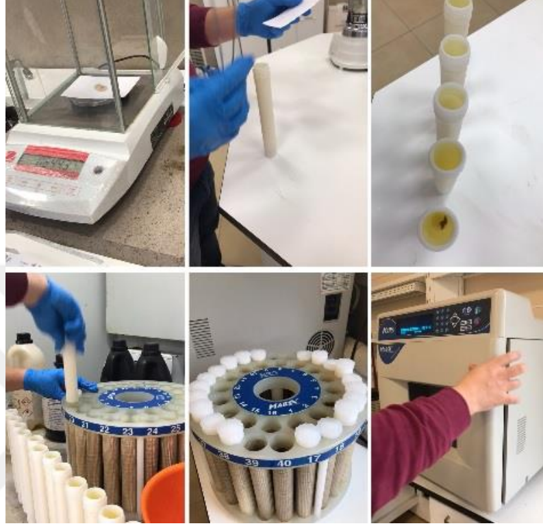
Şekil 3.4.1 Balık dokularının ICP-MS okumalarına hazırlanması
