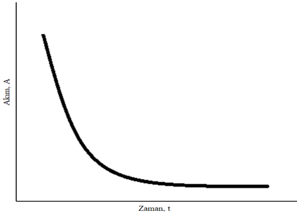
Şekil 3.3. Sabit potansiyelli elektroliz sırasında akım değişimi.
