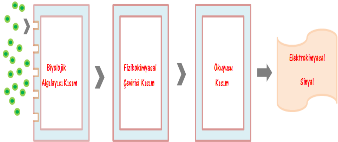
Şekil 2.2. Biosensörlerin genel çalışma mekanizması.
