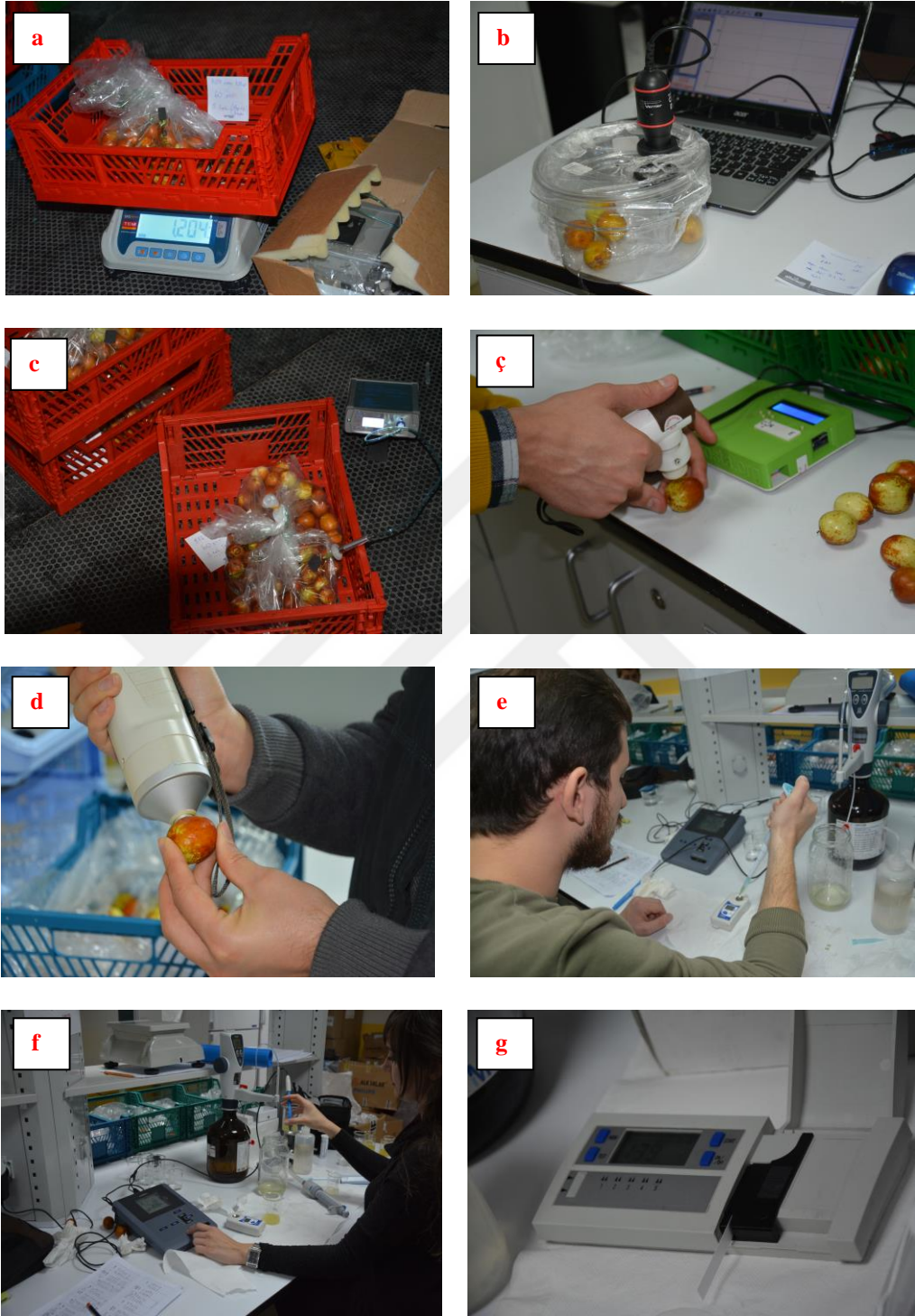
Şekil 3.3. Ağırlık kaybı (a), solunum hızı (b), gaz konsantrasyonu ölçümü (c), meyve sertliği (ç), meyve rengi (d), SÇKM (e), titre edilebilir asitlik (f) ve C vitamini (g) ölçümüne ait görünüm
