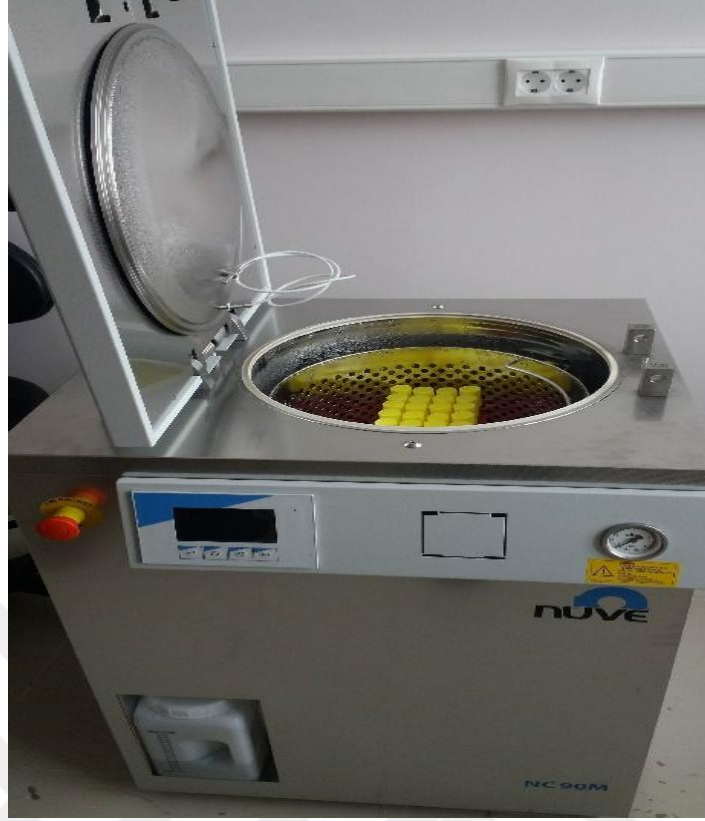
Şekil 3.3 Hazırlanan ortamların otoklavda sterilizasyon görünümü
