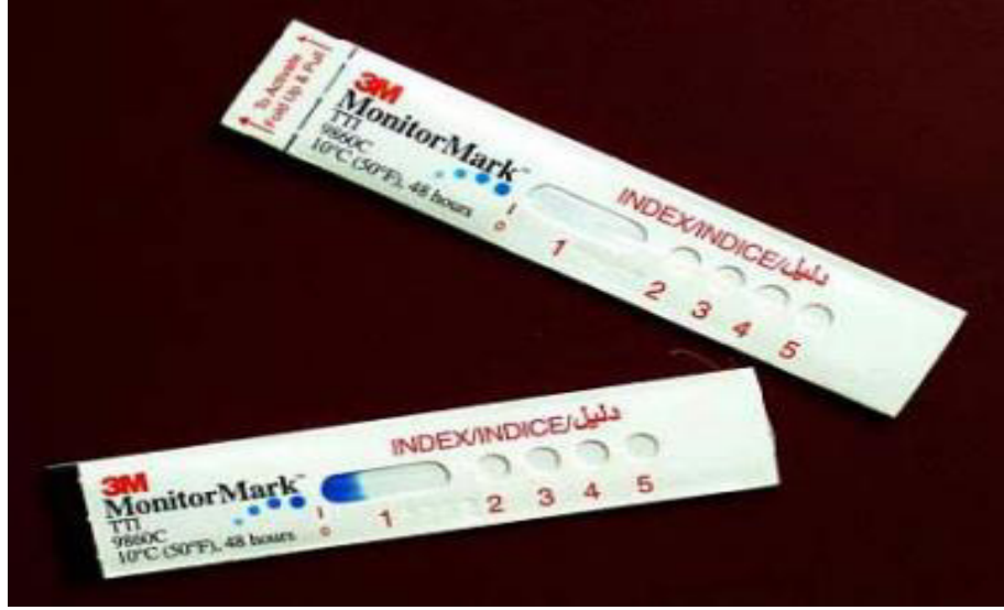
Şekil 2.3 3M Monitör Mark Moleküler Difüzyon Bazlı Zaman-Sıcaklık İndikatörü
