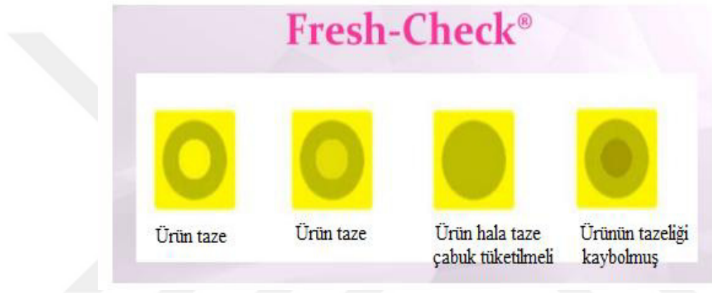
Şekil 2.5 Fresh-Check Polimer Bazlı Zaman-Sıcaklık İndikatörleri (Anonim, 2011)
