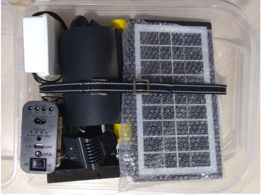
Şekil 3.20 Hibrid Mobil Sitemin Taşıma Çantasına Yerleştirilmesi
