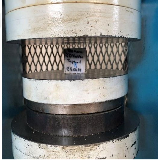
Şekil 3.14 Numunelerin basınç deneyi
