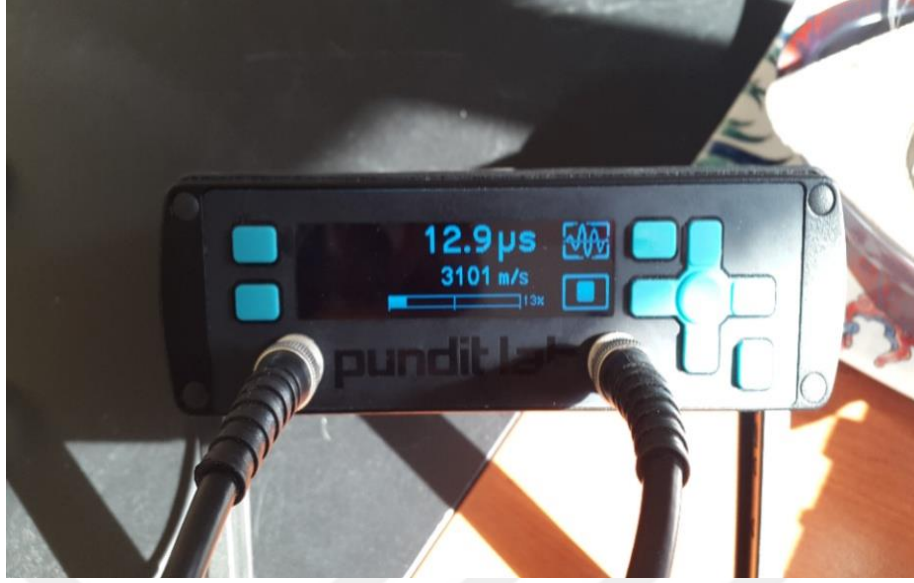
Şekil 3.8 Ultrasonic Pulse Velocity (UPV) cihazı
