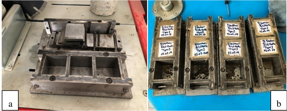
Şekil 3.6 Numune kalıpları (50 x 50 x 50 mm)(a,b)
