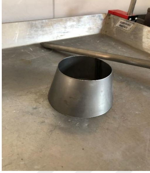
Şekil 3.12 Mini çökme deney seti
