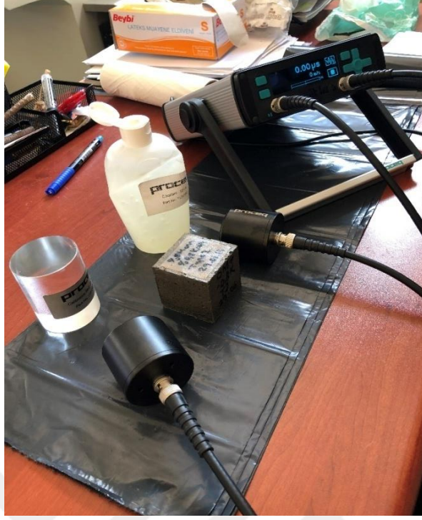
Şekil 3.15 Ultrases geçiş hızı ölçümü
