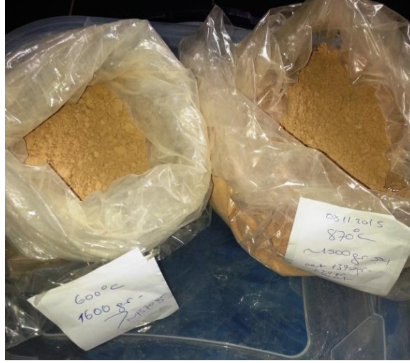
Şekil 3.1. Çalışmada kullanılan kalsine edilmiş marn örnekleri
