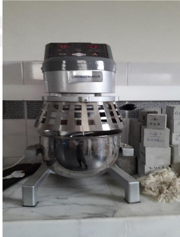
Şekil 3.10 Çimento harç karıştırıcı
