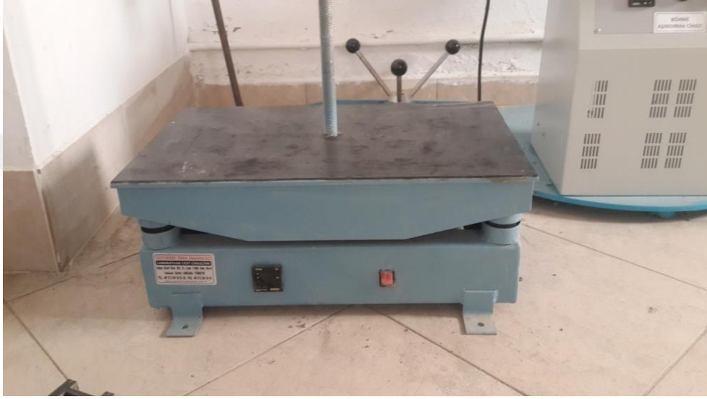
Şekil 3.11 Numunelerin yerleştirilmesinde kullanılan sarsma tablası
