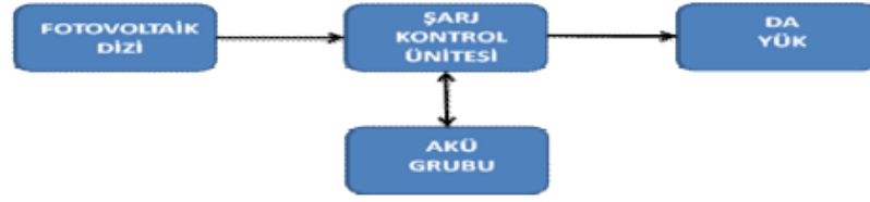
Şekil 3.4 Şarj kontrollü akülü PV sistem tasarımı
