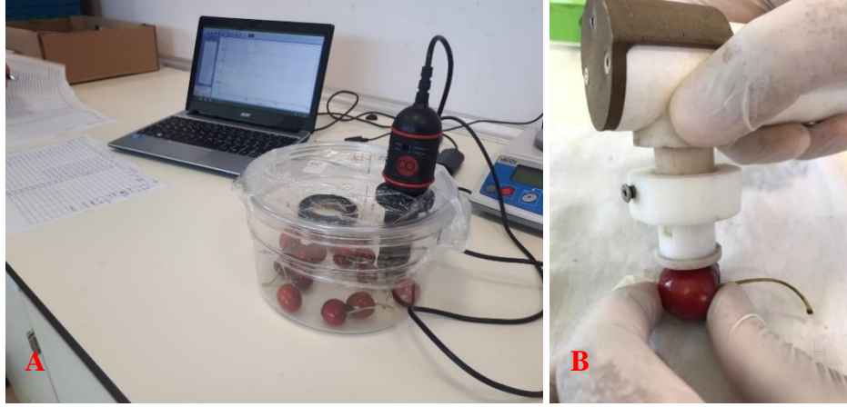
Şekil 3.4 Kiraz meyvelerinde solunum (A) ve sertlik ölçümü (B)
