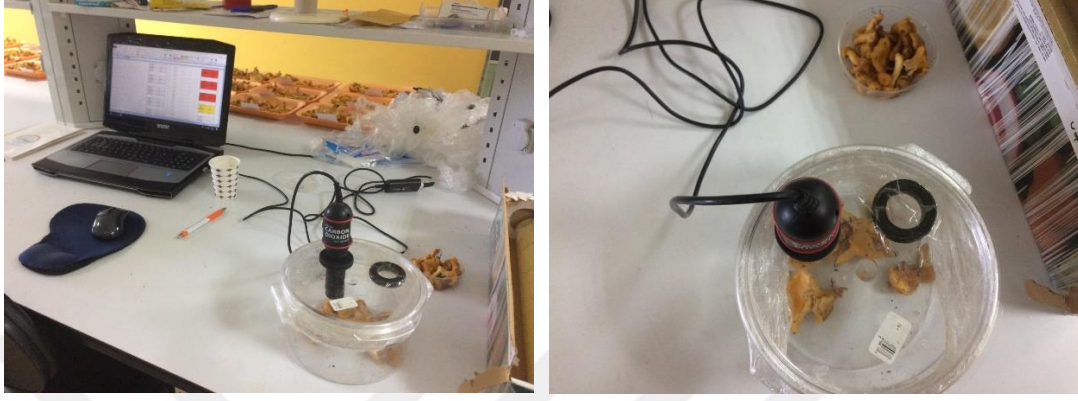
Şekil 3.6 Mantarlarda solunum ölçümüne ilişkin görünüm
