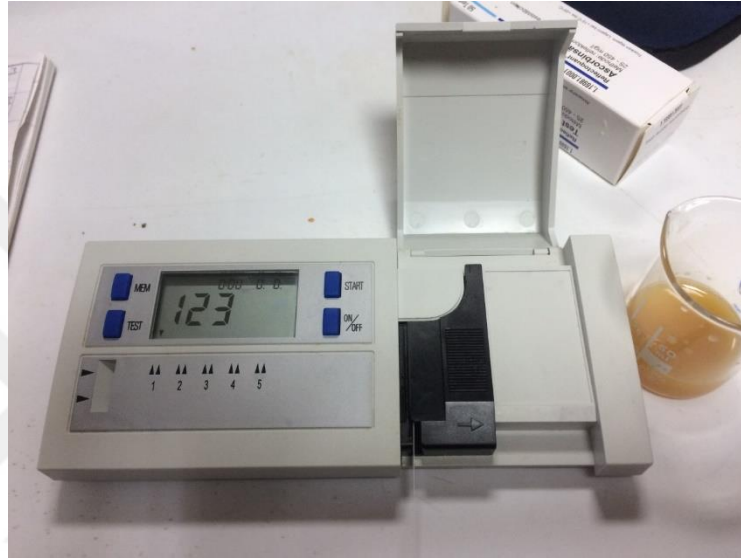
Şekil 3.7 Mantarlarda C vitamini ölçümüne ilişkin reflektometre görünümü
