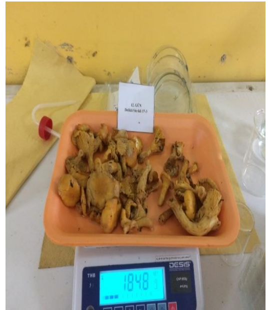
Şekil 3.4 Mantarlarda ağırlık kaybı ölçümüne ilişkin görünüm
