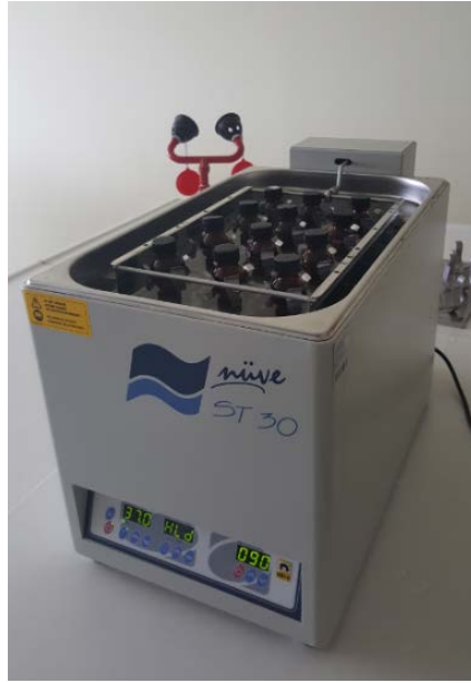
Şekil 3. 1 Biyobozunma çalışmalarında kullanılan çalkalama düzeneği.
