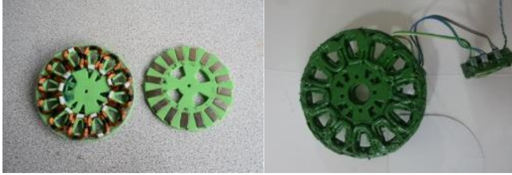
Şekil 2.22 Bobinler Stator ve 16 Mıknatıslı Rotor
