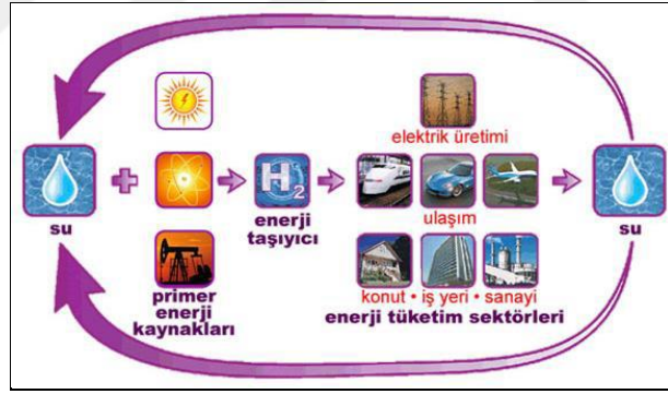
Şekil 1.8 Hidrojen Enerjisi Sistemi (Veziroğlu, 2006)
