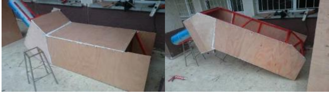
Şekil 2.10 OWC Sisteminin Üretim Aşaması (Kaplama)
