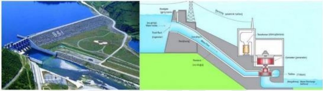
Şekil 1.3 Hidroelektrik Santral ve Hidrolik Enerji Üretim Şeması
