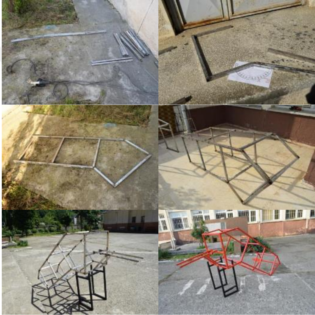
Şekil 2.9 OWC Sisteminin Üretim Aşamaları (İskelet)
