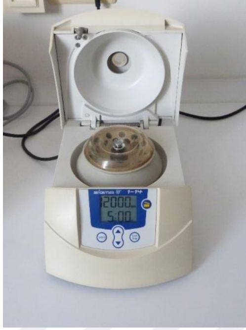
Şekil 3.4 Genomik DNA İzolasyonunda Kullanılan Santrifüj (Sigma D-37520)
