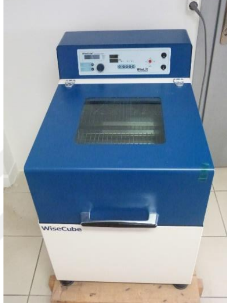
Şekil 3.3 Genomik DNA İzolasyonunda Kullanılan Sarsaklı İnkübatör (Wise WiseCube WIS-20)
