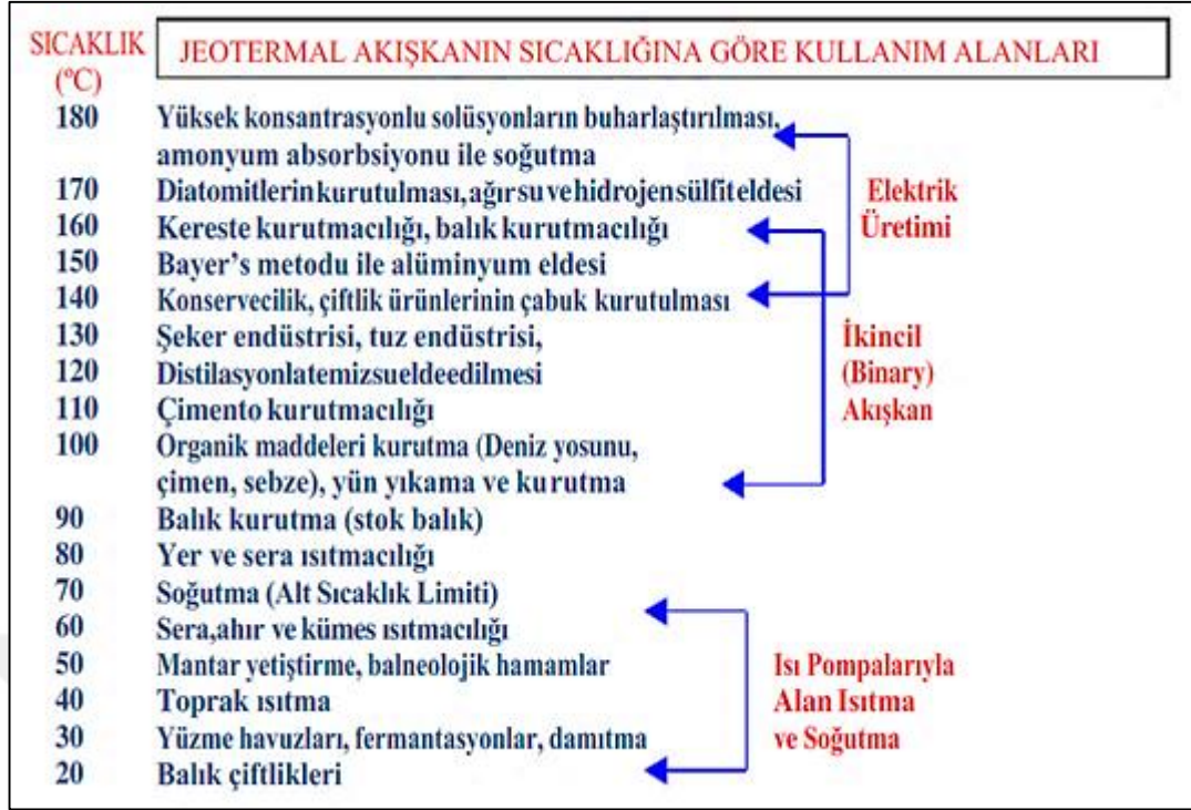
Şekil 3.4 Jeotermal Akışkanın Sıcaklığına Göre Kullanım Alanları (Lindal, 1973)
