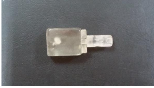
Resim 3. Otopolimerizan akrilik rezinden elde edilen örnek kopyası.
