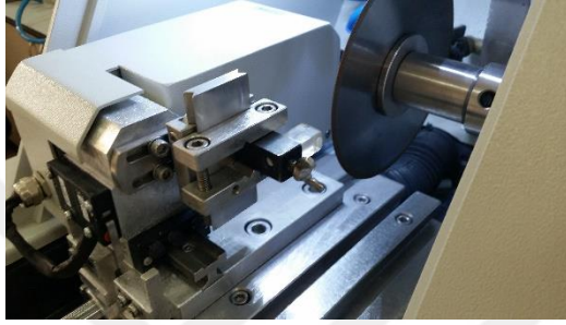
Resim 4. Tutucu aparata yerleştirilen blok kopyasının cihaza yerleştirilmesi.
