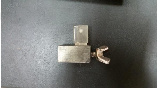
Resim 2. Örneklerin cihaza yerleştirilmesi için hazırlanan tutucu aparat.
