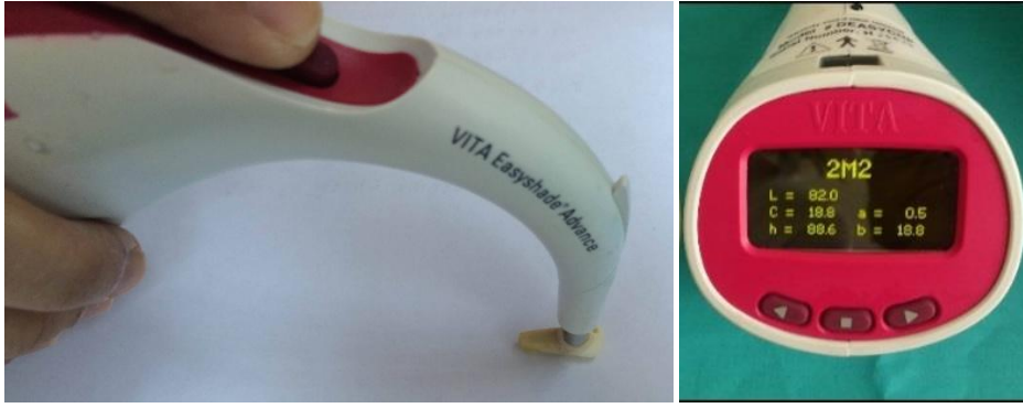
Şekil 3.4. Spektrofotometre ile renk ölçümünün yapılması
