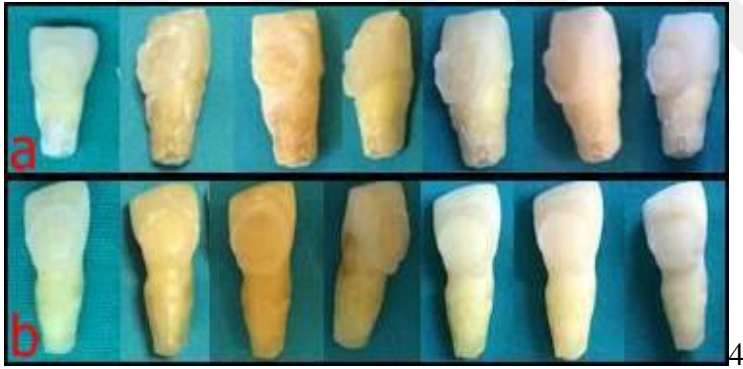
Şekil 3.11. a. Grup 4a'da bir örneğin başlangıç, renklenme (1., 2., 3. Hafta) ve ağartma (4., 8., 12. Gün) görüntüsü b. Grup 4b'de bir örneğin başlangıç, renklenme (1., 2., 3. Hafta) ve ağartma (4., 8., 12. Gün) görüntüsü
