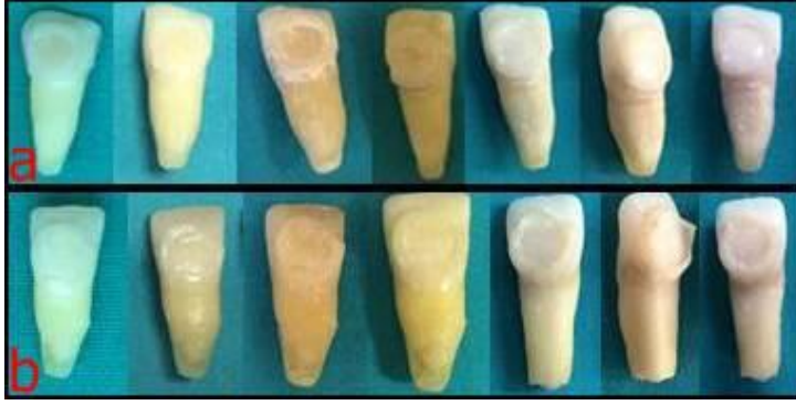
Şekil 3.12. a. Grup 5a'da bir örneğin başlangıç, renklenme (1., 2., 3. Hafta) ve ağartma (4., 8., 12. Gün) görüntüsü b. Grup 5b'de bir örneğin başlangıç, renklenme (1., 2., 3. Hafta) ve ağartma (4., 8., 12. Gün) görüntüsü
