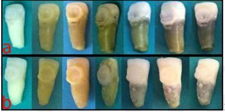
řekil 3.8. a. Grup 1a'da bir rneęin bařlangıç, renklenme (1., 2., 3. Hafta) ve aęartma (4., 8., 12. Gn) grnts b. Grup 1b'de bir rneęin bařlangıç, renklenme (1., 2., 3. Hafta) ve aęartma (4., 8., 12. Gn) grnts
