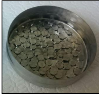
Şekil 3.1: 5 mm çapında ve 1 mm kalınlığında makinelanmış Grade 4 saf titanyum diskler.
