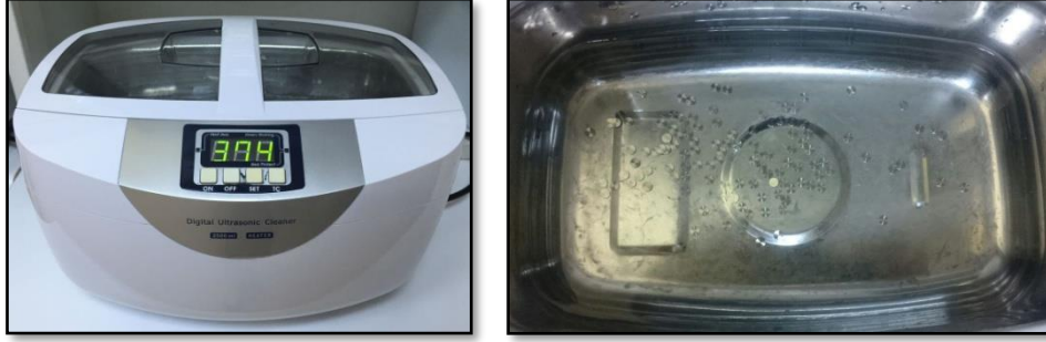
Şekil 3.2: Dezenfeksiyon işleminin gerçekleştirildiği ultrasonik temizleyici
