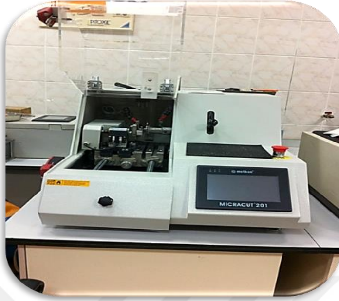
Şekil 3.5: Örnekleri kesmek için kullanılan düşük hızlı, su soğutmalı kesme aleti
