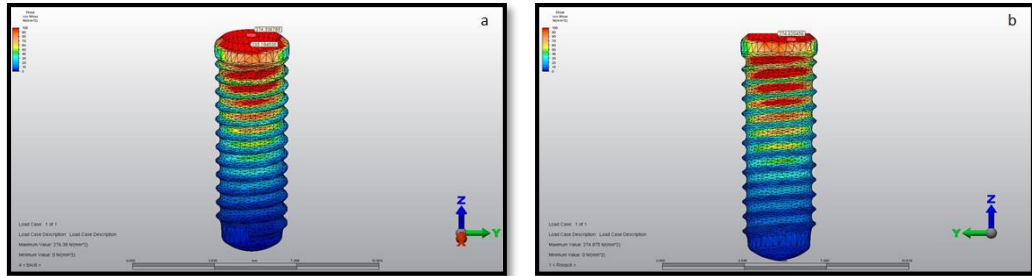
Şekil 4.24: Oblik kuvvet uygulanan mandibular modellerde implantlara ait Von Mises gerilme değerleri ve dağılımları: a) Ti implant, b) Ti-Zr implant.
