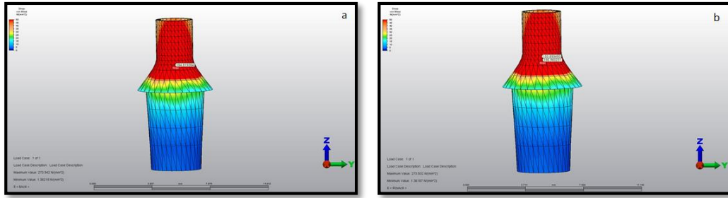
Şekil 4.25: Oblik kuvvet uygulanan maksiller modellerde dayanağa ait Von Mises gerilme değerleri ve dağılımı: a) Ti dayanak, b)Ti-Zr dayanak.
