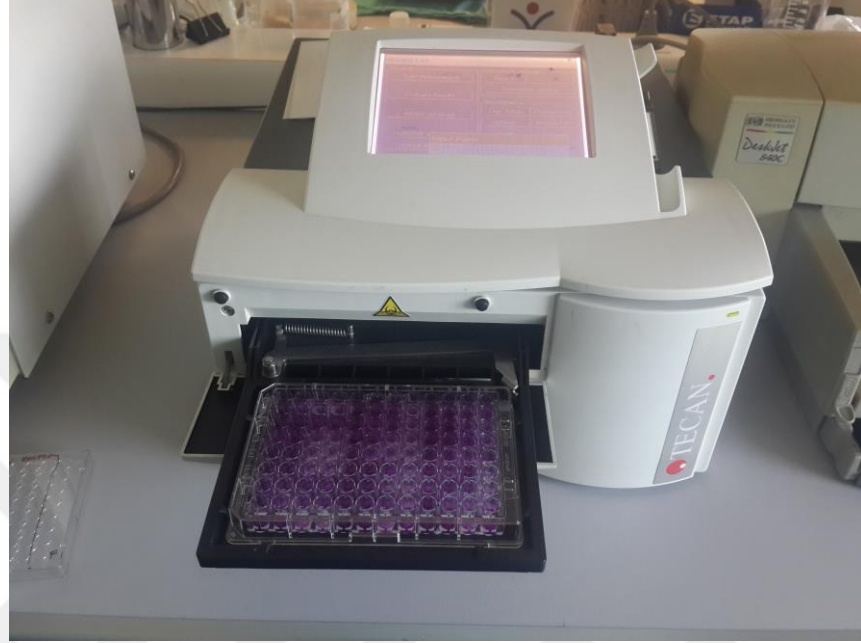
Şekil 3.8. Renk yoğunluğunun (OD) mikroyeokuyucusu ile 570 nm'de belirlenmesi
