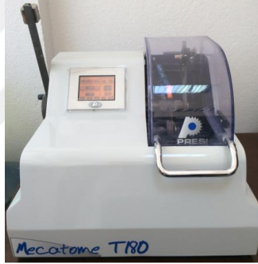
Şekil 12. Çalışmada kullanılan kesit alma cihazı
