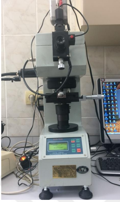
Şekil 27. Çalışmamızda kullandığımız Vicker's mikrosertlik cihazı
