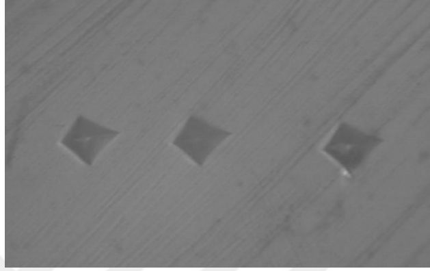
Şekil 41. Vita Enamic 0,5 mm kalınlık grubunda Vicker's mikrosertlik testinden sonra rezin simanın yüzey görüntüsü
