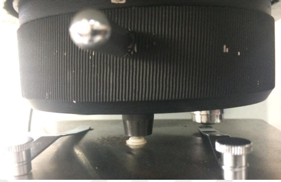
Şekil 29. Örneklerin yüzeyine mikrosertlik testi için kuvvet uygulanması
