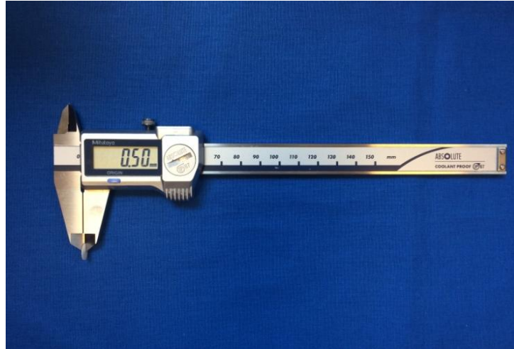
Şekil 15. 0.5 mm çapındaki örneklerin dijital mikrometre ile ölçülmesi
