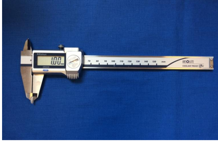
Şekil 16. 1 mm çapındaki örneklerin dijital mikrometre ile ölçülmesi
