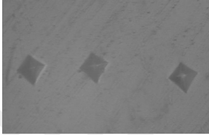
Şekil 38. Lava Ultimate 0,5 mm kalınlık grubunda Vicker's mikrosertlik testinden sonra resin simanın yüzey görüntüsü
