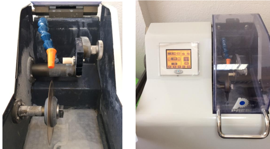
Şekil 13. Kesit alma cihazı kullanılarak bloklardan kesit alınması
