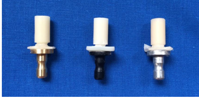
Şekil 11. Frezeleme işleminden sonra silindirik haline gelen rezin matrisli seramik bloklar
