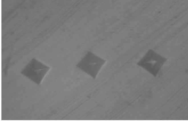
Şekil 43. Vita Enamic 1,5 mm kalınlık grubunda Vicker's mikrosertlik testinden sonra rezin simanın yüzey görüntüsü
