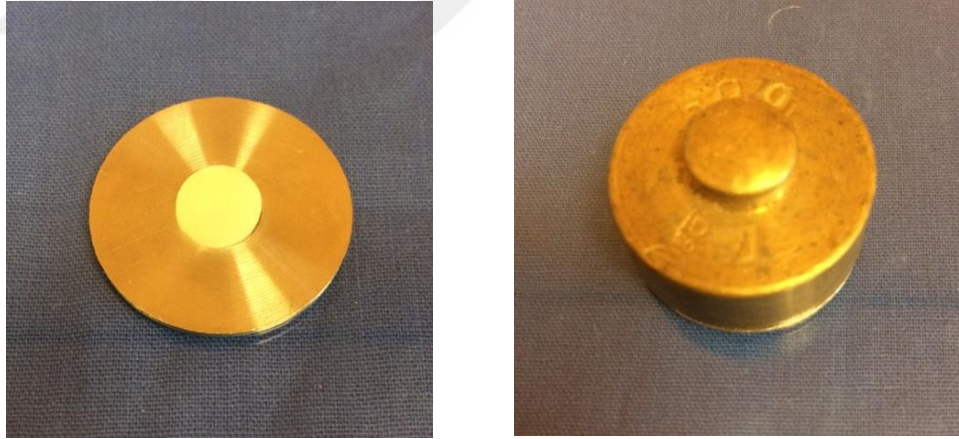
Şekil 24. Resin simanın üzerine resin matris seramik örneklerin yerleştirilmesi ve üzerine 500 g'lık kuvvet uygulanması
