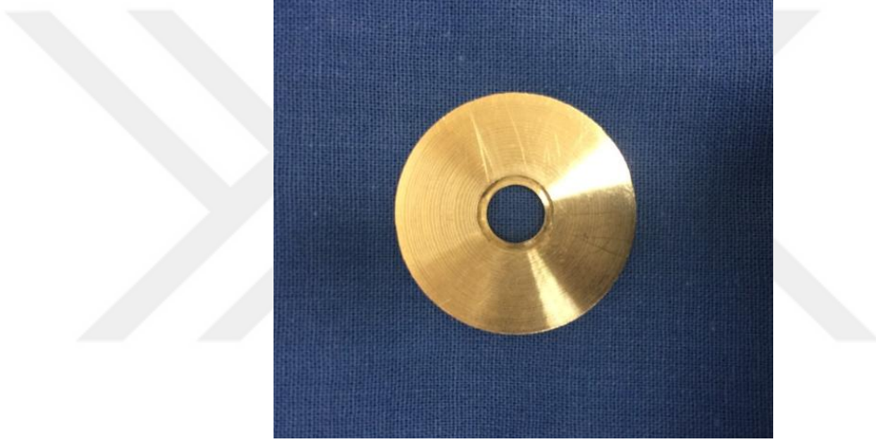
Şekil 20. Rezin siman örneklerini standardize etmek için hazırlanan paslanmaz çelik kalıp
