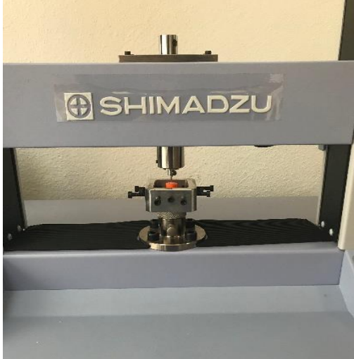
Şekil 12. Push-out bağlanma dayanımı testinin yapıldığı universal test cihazı
