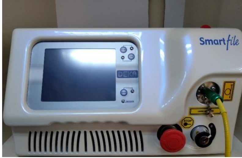
Şekil 3.2. Çalışmada kullanılan Nd-YAG lazer cihazı
