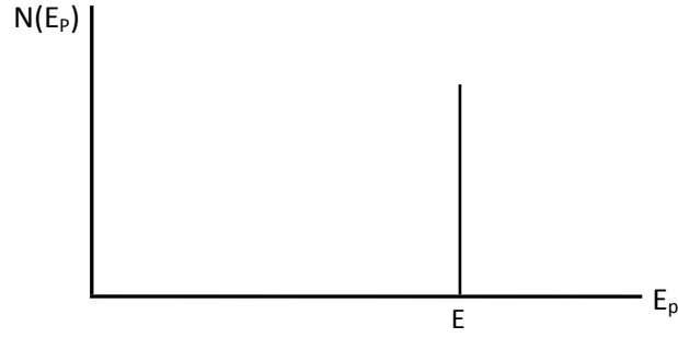
Şekil 2.10. Tek enerjili bir kaynağın ideal spektrumu (kaynak spektrum) (Almaz, 2007)
