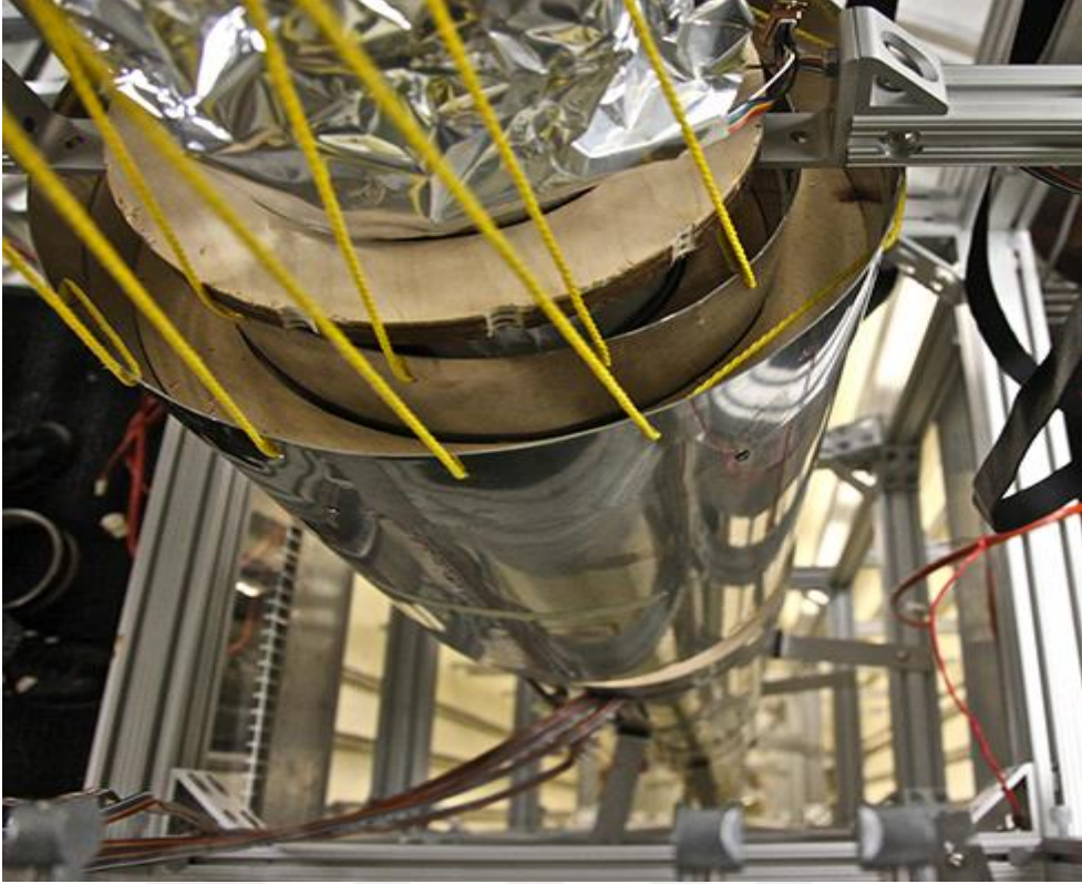
Şekil 2.3. Bunun gibi bir atom saati, yılda bir mikrosaniye hassasiyetinde zaman tutmak için sezyum atomlarının titreşimlerini kullanır. Temel zaman birimi, saniye ise bu tür saatlere dayanıyor. Bu görüntü atomik bir saatin tepesinden aşağı bakıyor (URL-2).
