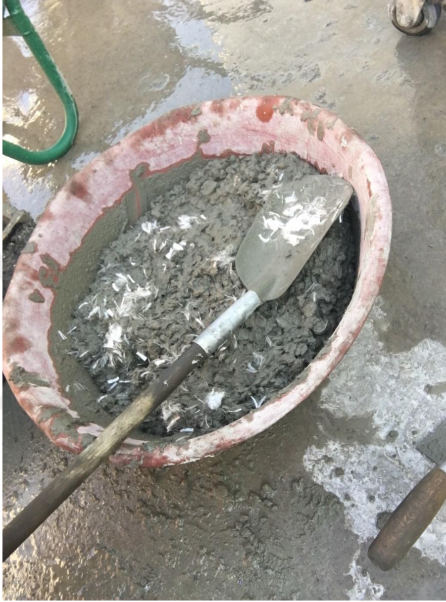
Şekil 4.4.Polipropilen elyaf liflerin betona karma işlemi
