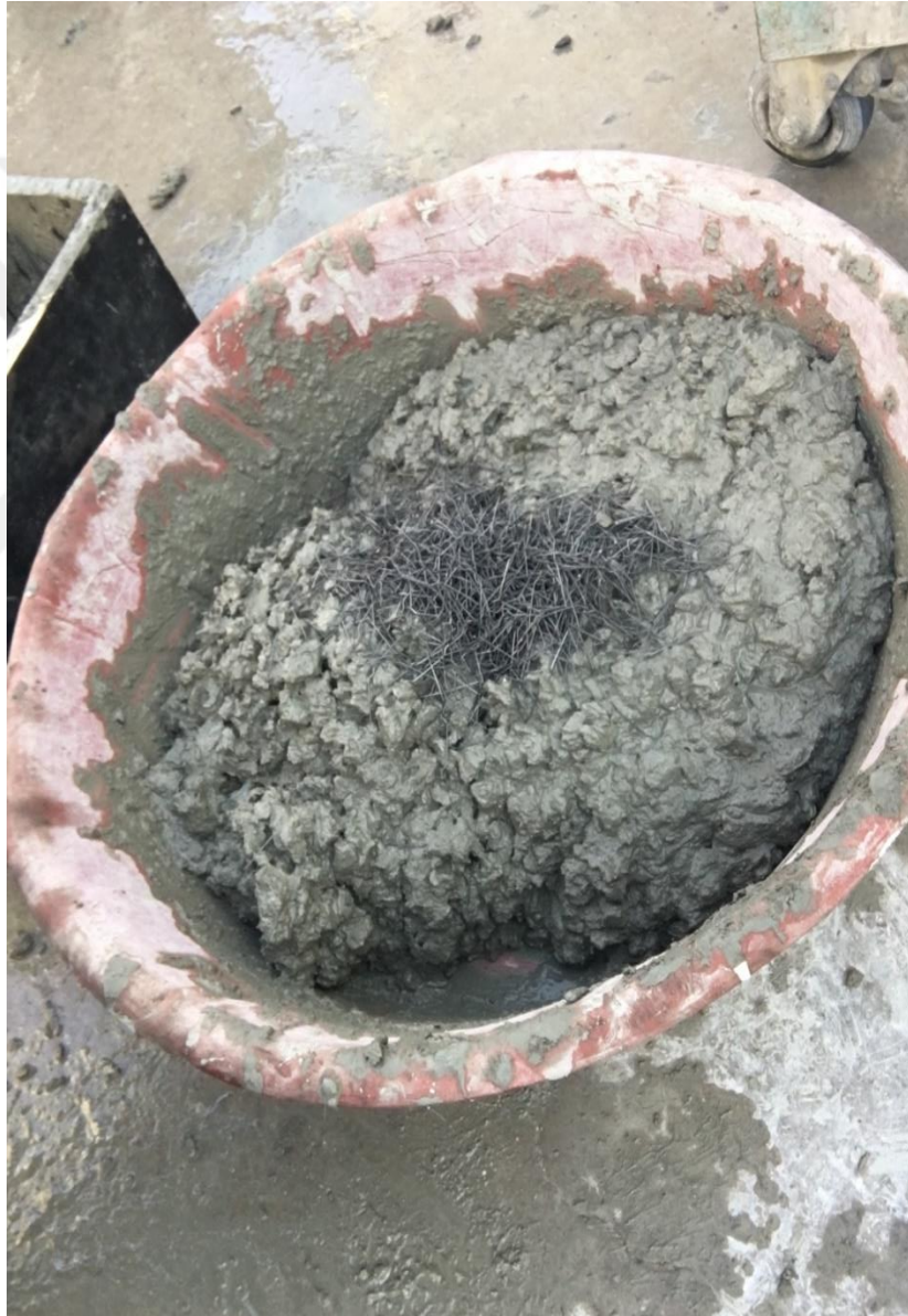
Şekil 4.7.HE0735 çelik lifinin betona karma işlemi
