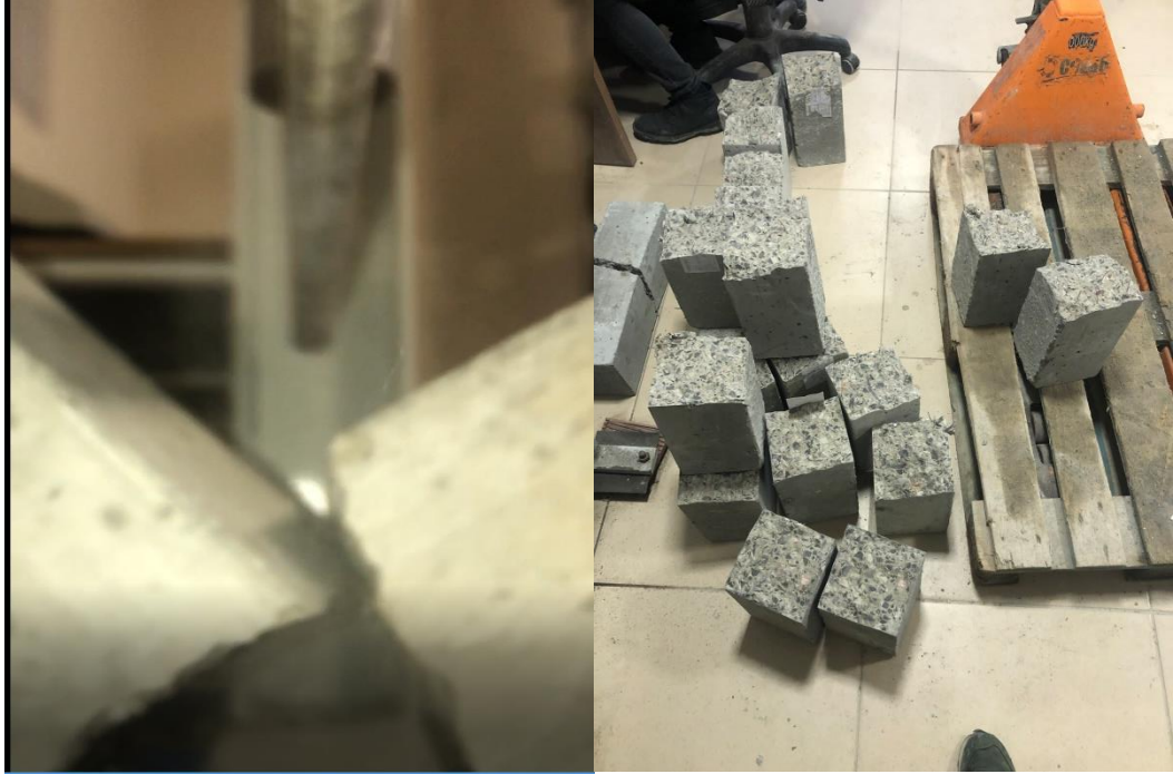
Şekil 4.33.Kontrol kirişinin eğilme deneyi sonrası görüntüsü
