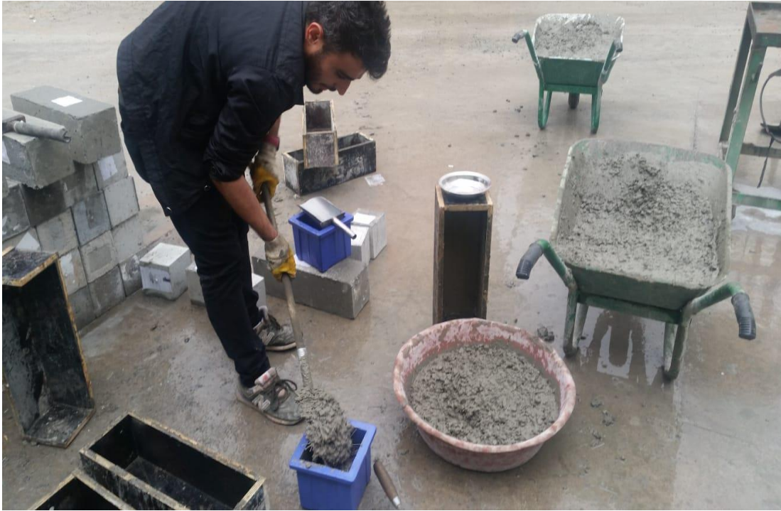
Şekil 4.14.Karma lifli betonun kalıplara yerleştirilmesi
