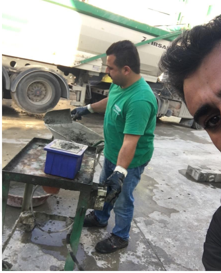
Şekil 4.5.Lifli betonun kalıplara masa vibratörü ile yerleştirilmesi
