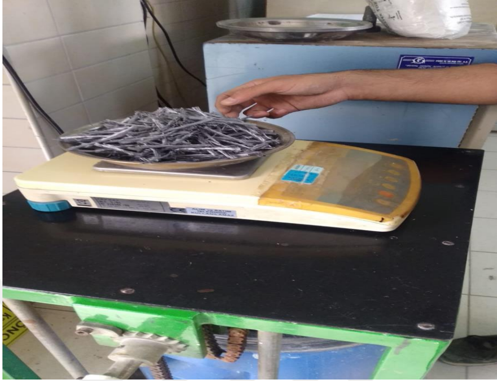
Şekil 4.12.Macromesh54 sentetik lifinin sarfiyat ölçümü
