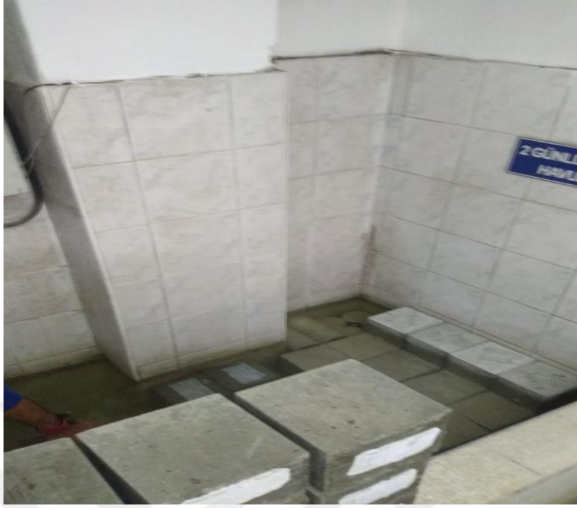
Şekil 4.18. Deney numunelerinin kür havuzuna alınması
