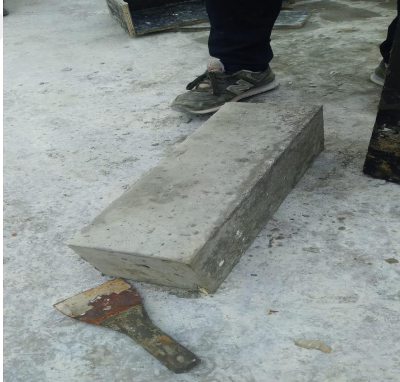
Şekil 4.17. Kiriş numunesi kalıplarının sökülmesi
