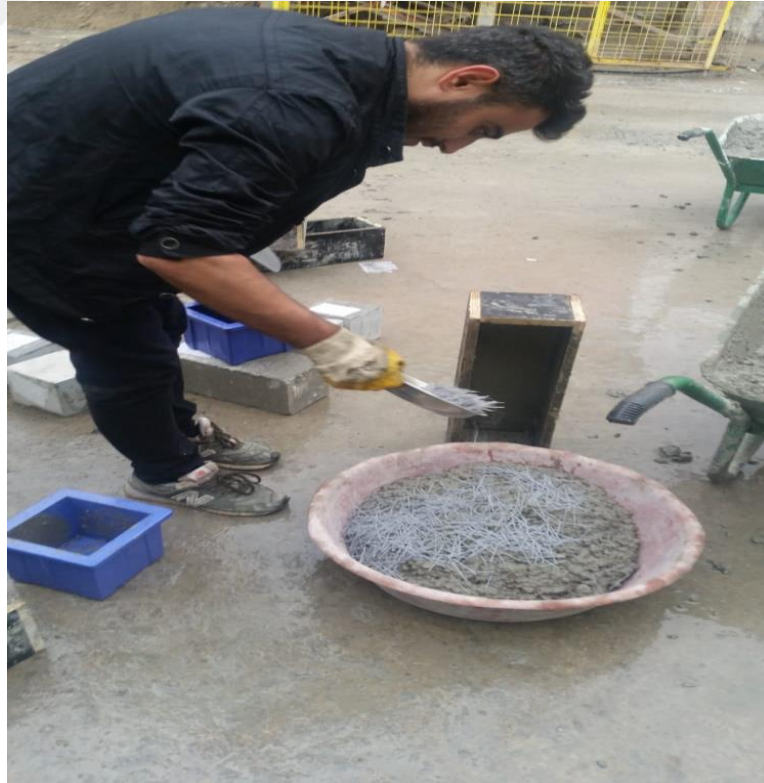
Şekil 4.10.Enduro prime sentetik liflerin betona karma işlemi
