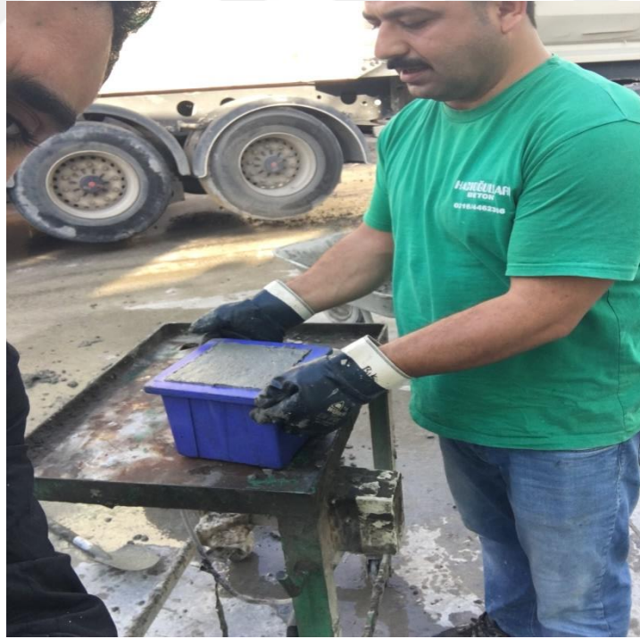
Şekil 4.15.Karma lifli betonun masa vibratörüyle kalıplara yerleştirilmesi
