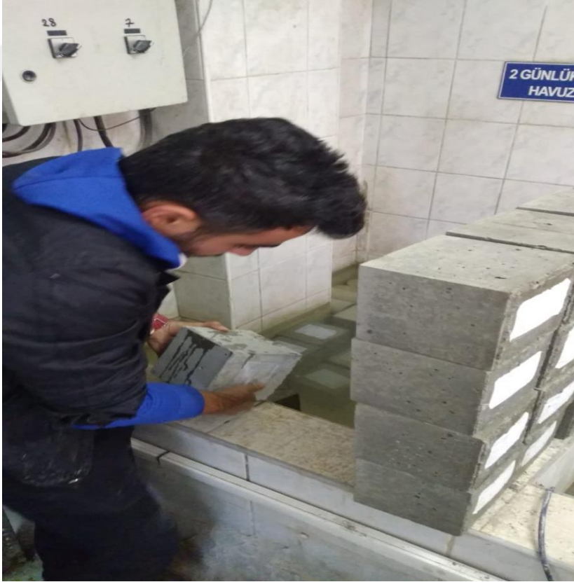
Şekil 4.19. Küp numunelerinin kür havuzuna alınması
