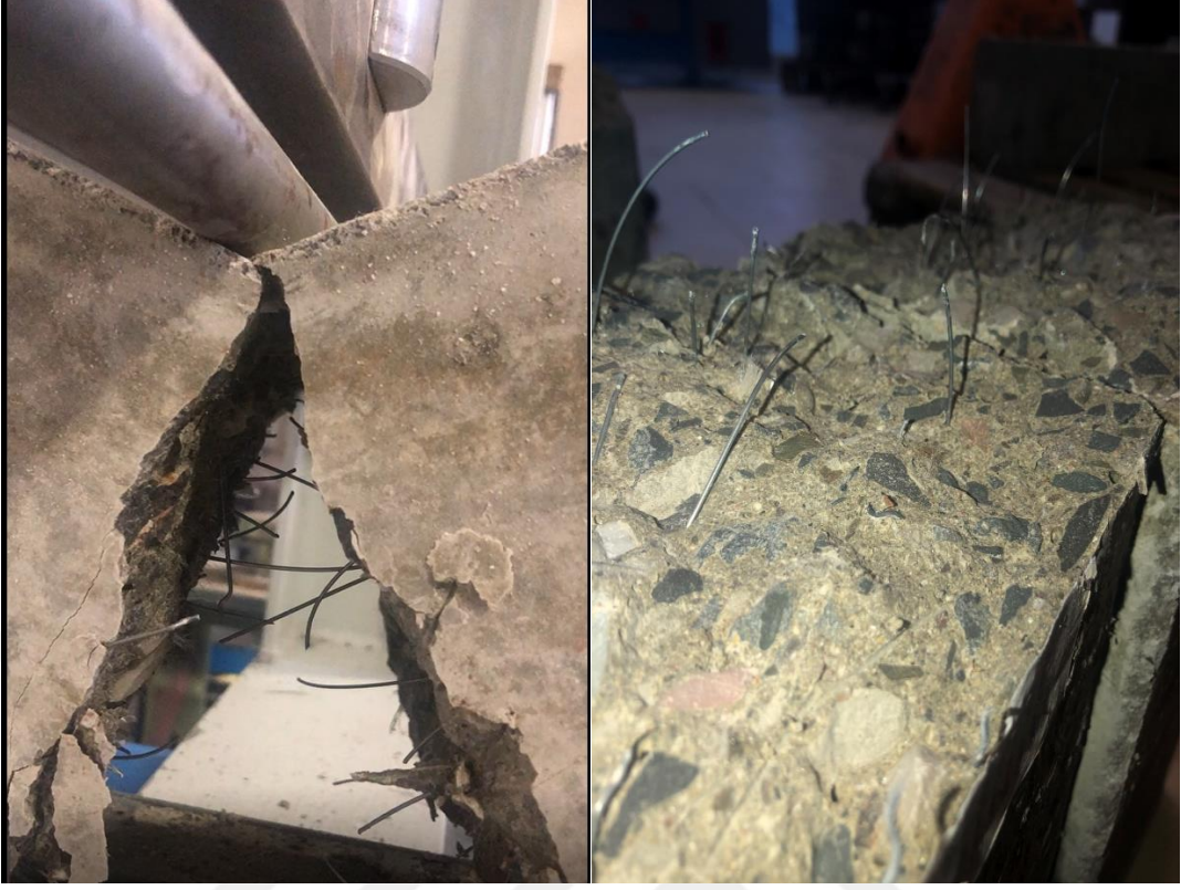
Şekil 4.30.Çelik lifli kirişin eğilme deneyi sonrası görüntüsü
