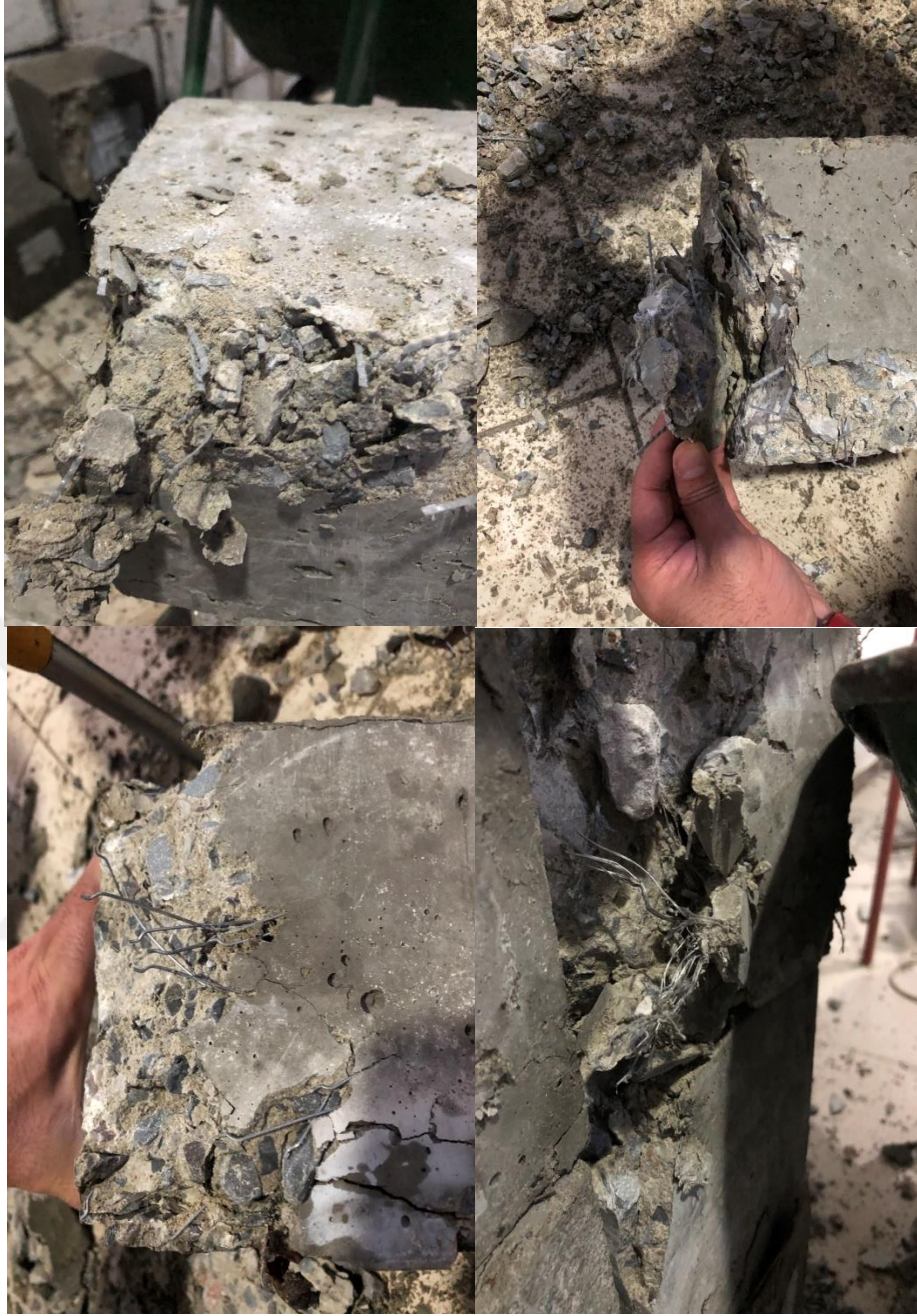
Őekil 4.24.Lifli k p numunelerin test sonrası g r nt leri
