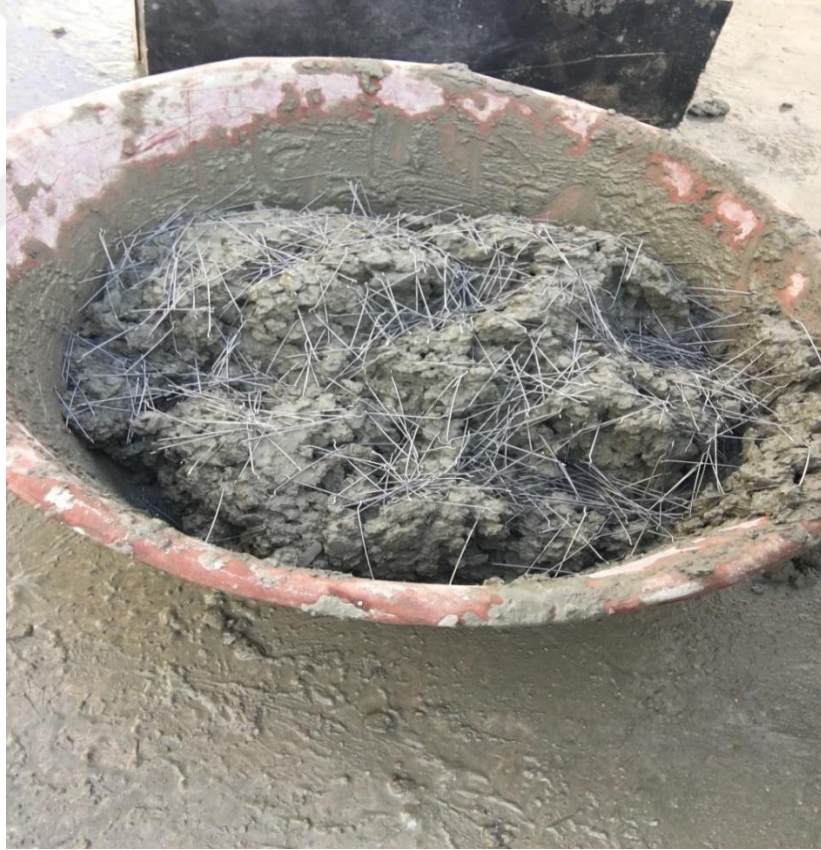
Şekil 4.9.HE0960 çelik lifinin betona karma işlemi
