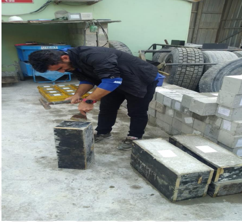
Şekil 4.16. Deney numunesi kalıplarının sökülmesi
