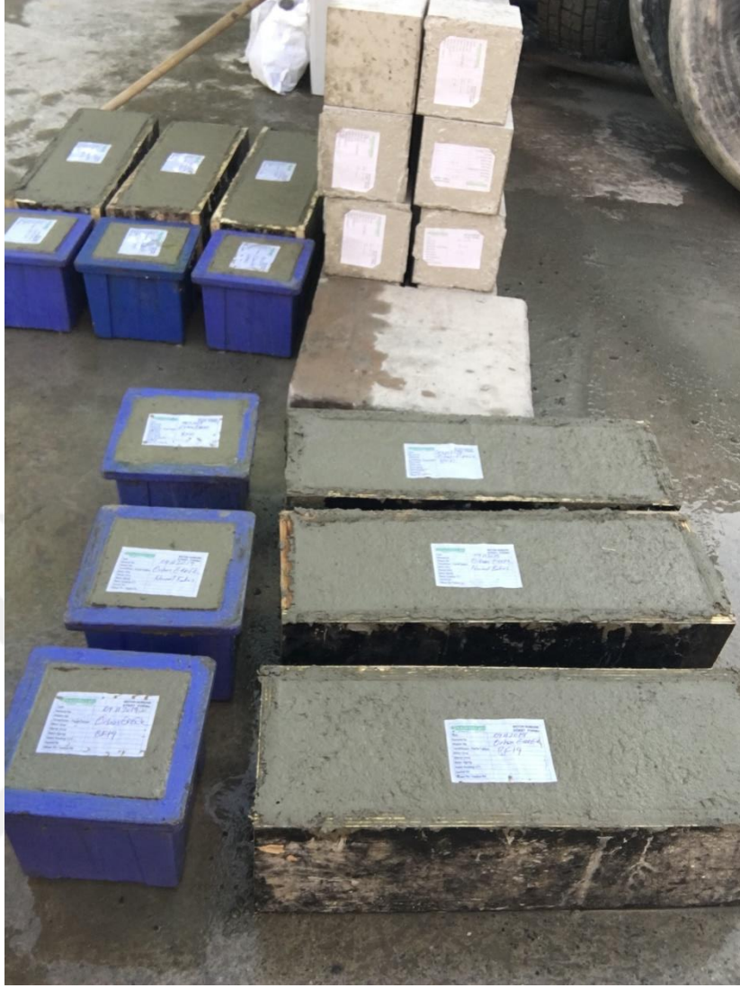
Şekil 4.6.Küp ve kiriş numunelerinin etiketlenmesi
