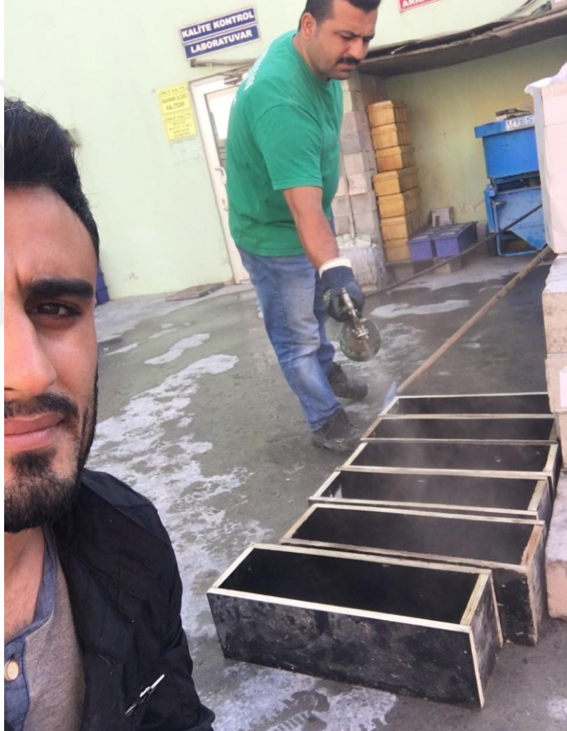
Şekil 4.1.Numune kalıpları ve kalıp yağlama uygulaması
