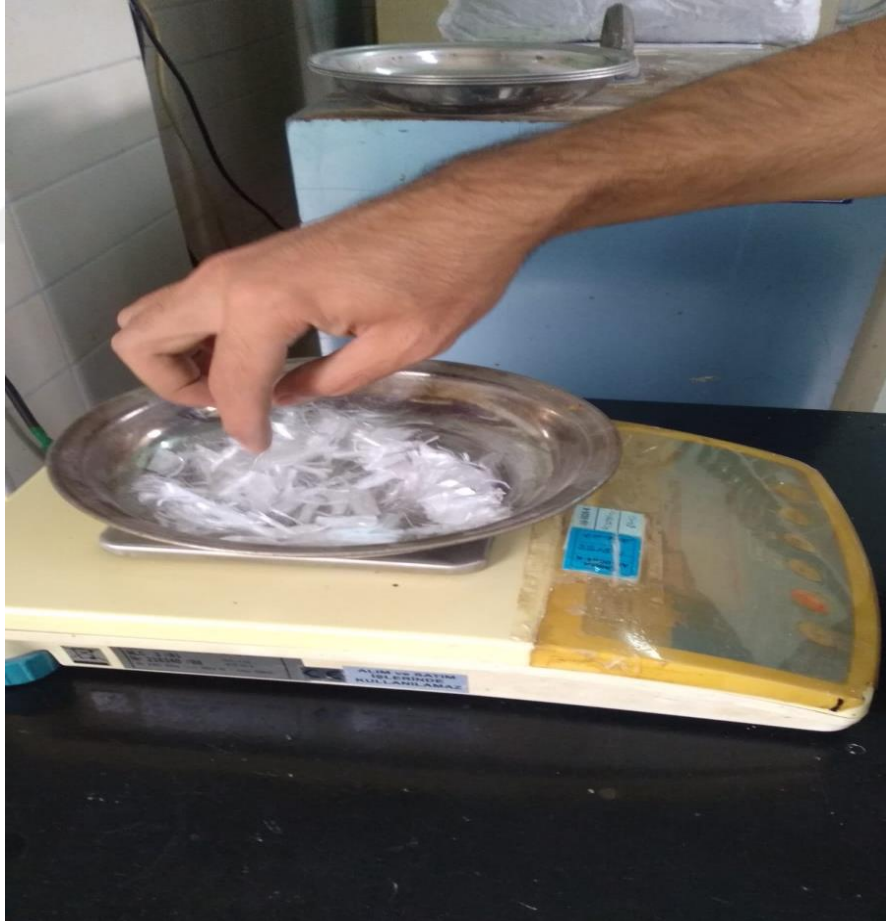
Şekil 4.3.Polipropilen elyaf lif sarfiyat ölçümü
