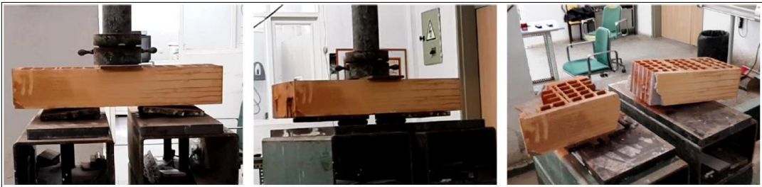
Şekil 39. Başlangıç kayma dayanımı için yükleme kesme göçmesi (Aras, 2018c)
