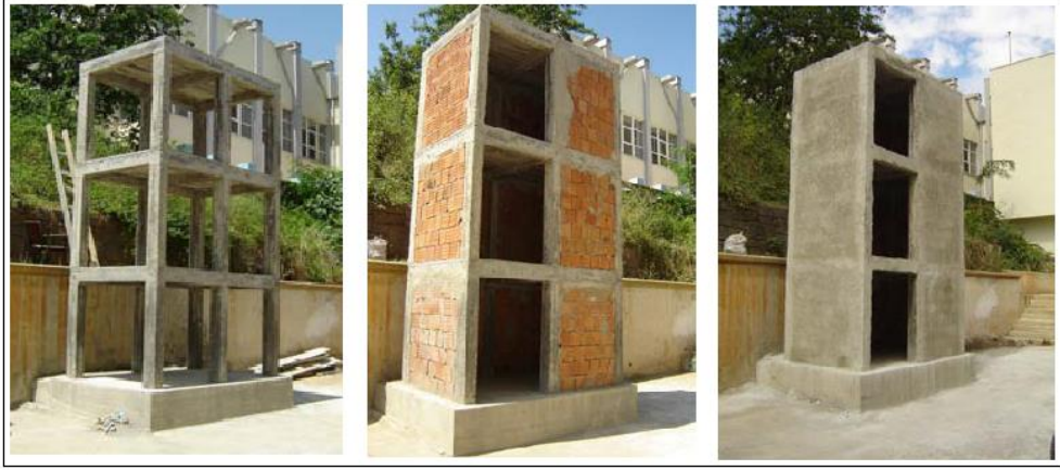
Şekil 18. Modelin karkas, tuğlalı ve sıvalı durumu (Türker ve Bayraktar, 2017)
