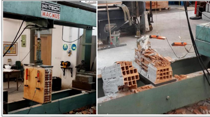
Şekil 38. Basınç testi ve göçen numune (Aras, 2018c)
