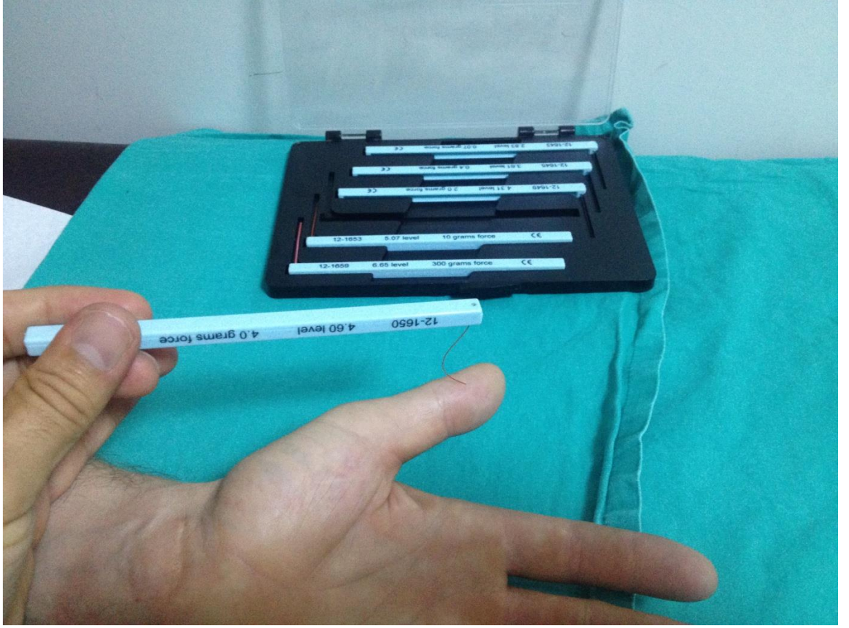
Resim 17. Monofilaman testinin uygulanışı
