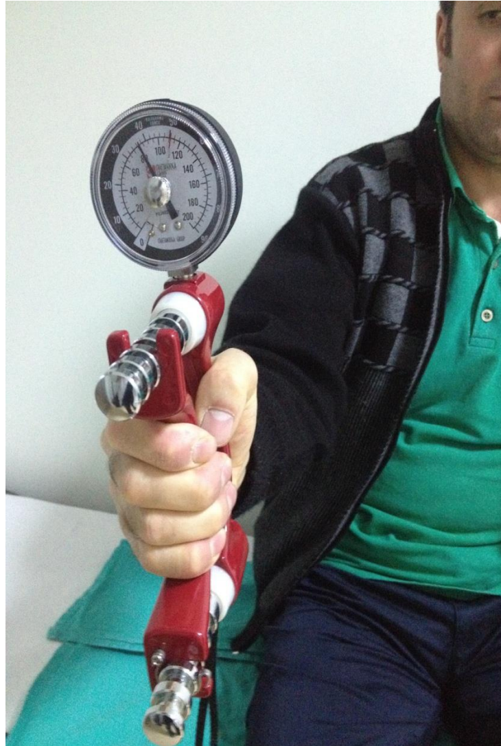
Resim 14: Hidrolik el dinamometresi ile kaba kavrama gücünün ölçüm yöntemi(ÖN)
