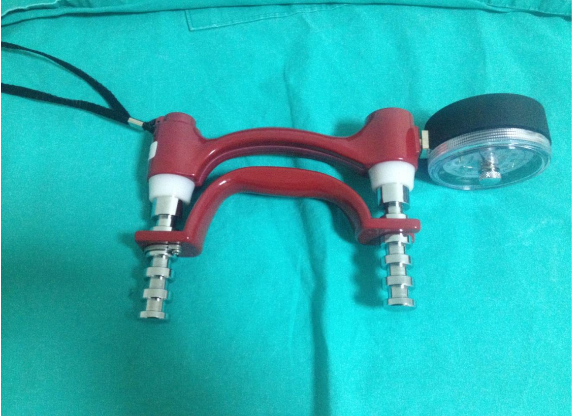
Resim 10. Hidrolik El Dinamometresi
