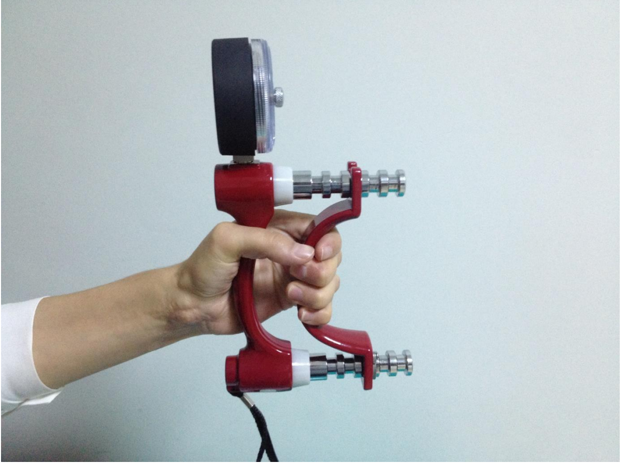
Resim 15: Hidrolik el dinamometresi ile kaba kavrama gücünün ölçüm yöntemi (YAN)
