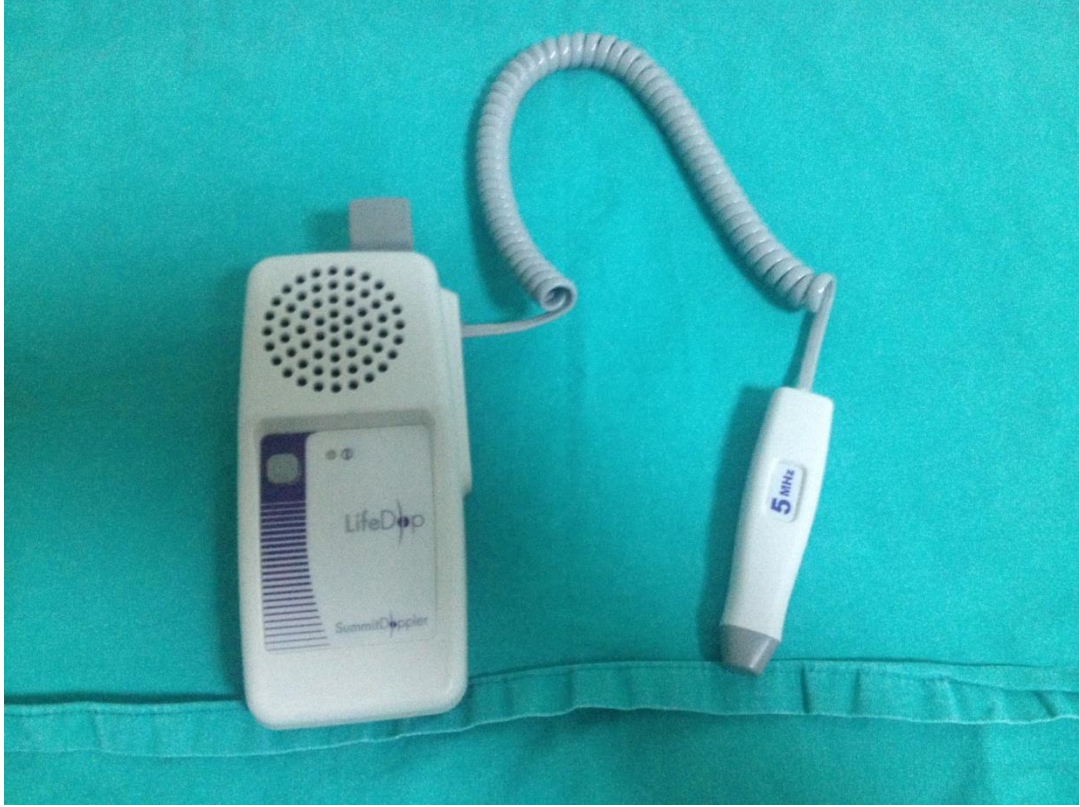
Resim 11. LifeDop Model (Marka adı: SUMMIT DOPPLER) El Vasküler Doppleri
