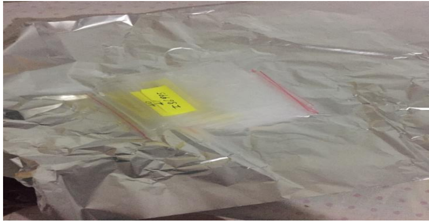
Resim 2.9. CR-39 Detektörlerinin pořetlere konulması
