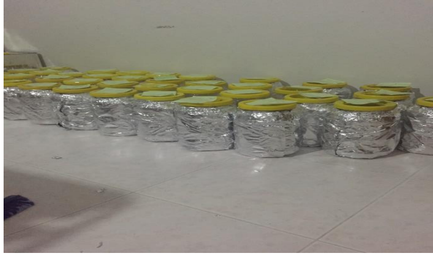
Resim 2.7. Toprak örneđi kaplarının alüminyum folyoyla kapatılması
