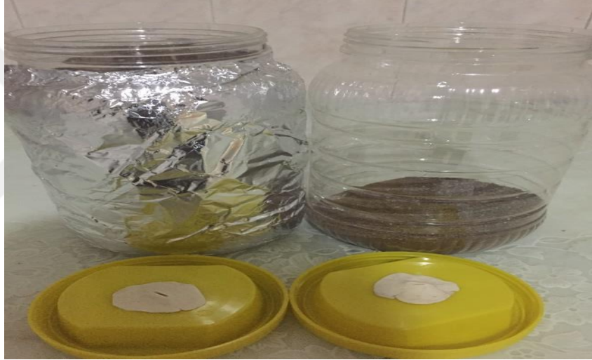
Resim 2.8. CR-39 Detektörlerinin kaplara yerleřtirilmesi
