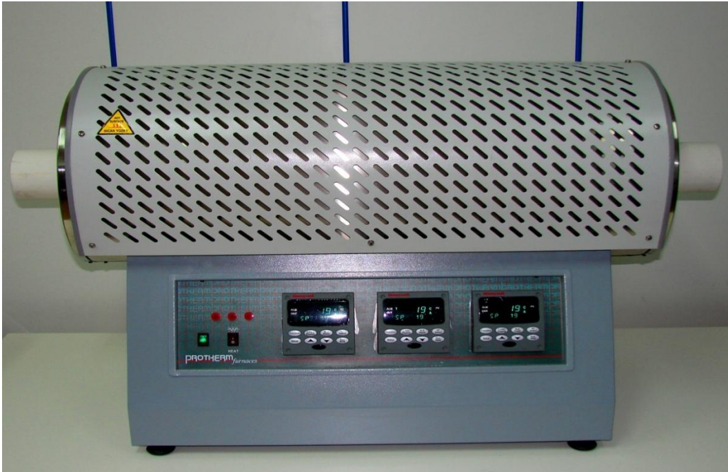
Şekil 2.4 PROTHERM programlanabilir tüp fırın
