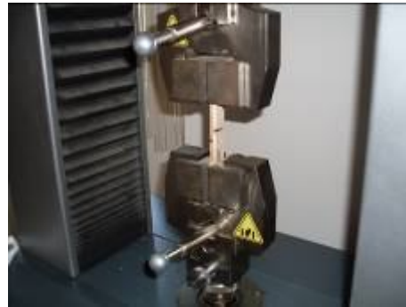
Şekil 3.17 Üniversal Deney Makinesinde yapışma direncinin yapılması
