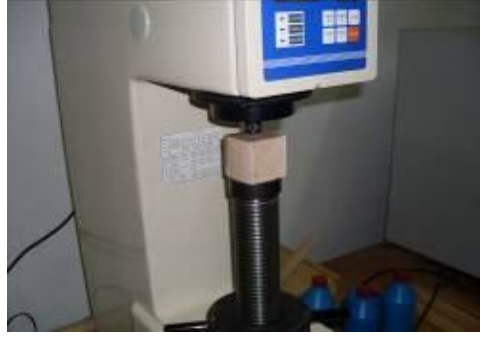
Şekil 3.15 Üniversal Deney Makinesinde Brinell Sertlik değerinin tespiti
