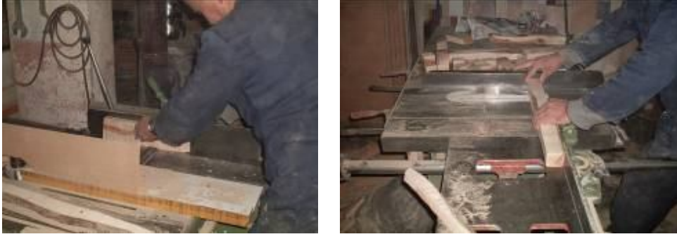
Şekil 3.8 Deney örneklerinin TSE ölçülerinde kesilmesi
