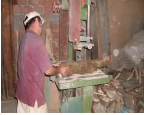
Şekil 3.6 Ağaçlardan deney örneği kesim yöntemi
