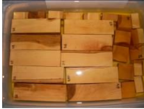
Şekil 3.10 Daralma yüzdelerini hesaplamada kullanılan örnekler
