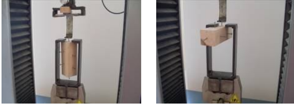
Şekil 3.18 Üniversal Deney Makinesinde çivi tutma direncinin yapılması
