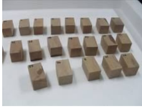
Şekil 3.9 Hava kurusu özgül ağırlık tayini örnekleri
