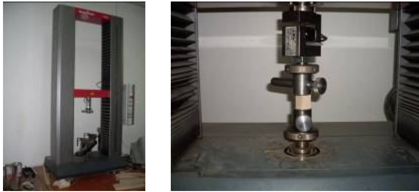
Şekil 3.12 Üniversal Deney Makinesi ve basınç direnci deneyi
