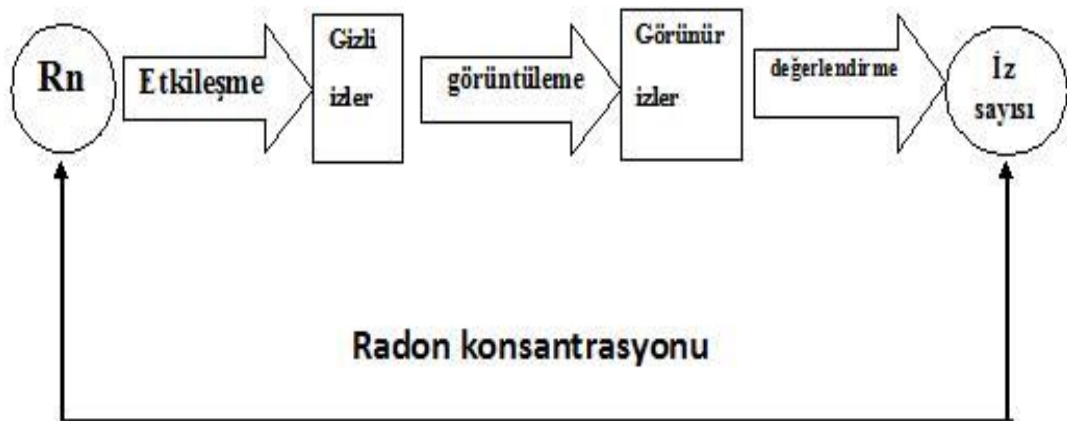
Şekil 2.13 Pasif radon detektörleri ile ölçme ve değerlendirme işlemlerinin şematik gösterimi ( Fişne vd. 2004).
