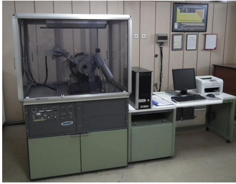
Şekil 5.2 Numunelerin kırınım deseninin alındığı Rigaku DMAX III model difraktometre
