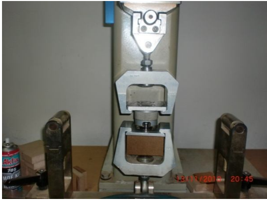
Şekil 3.9 Yüzeye paralel vida çekme
