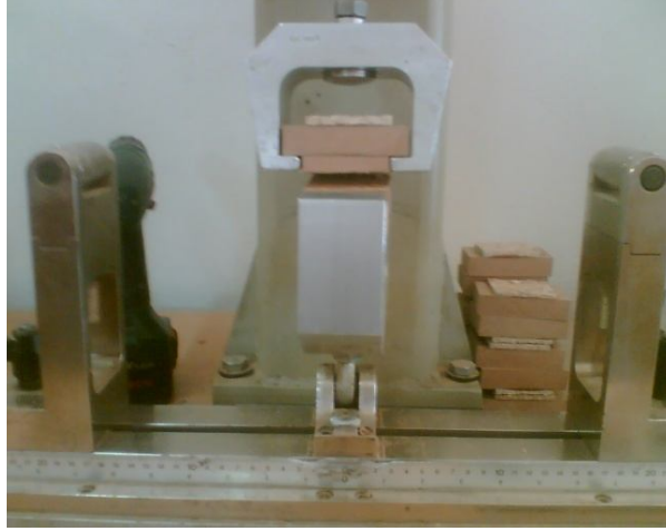
Şekil 3.7 Yüzeye dik yönde çekme direnci testi
