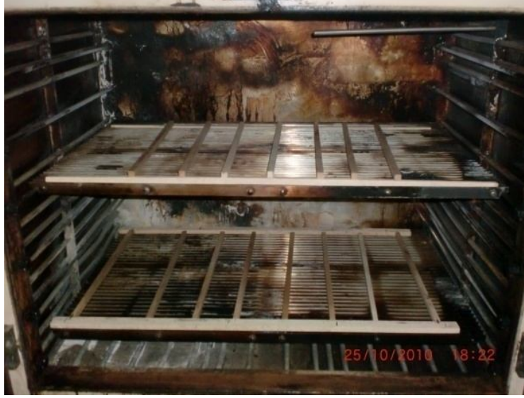
Şekil 3.2 Fırın içi ızgara ve çıtaların durumu
