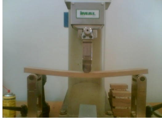
Şekil 3.8 Eğilme direnci testi
