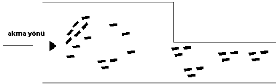
Şekil 7.1 Yüksek sürtünme nedeniyle boya konsantresindeki ufak farklılıklar [10].
