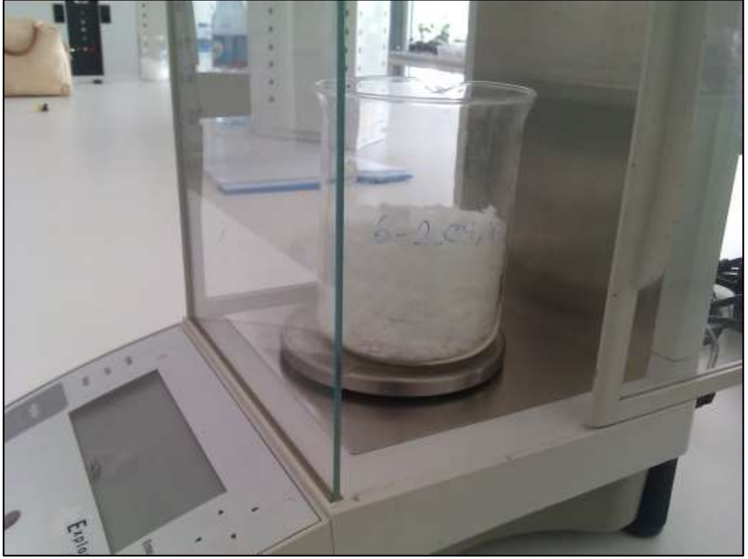
Şekil 3.4. Polietilen glikol (PEG 6000) çözeltilerinin hazırlanması
