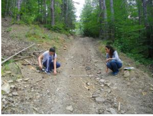
Fotoğraf 3.1. Durma noktalarında yol genişliğinin ölçülmesi
