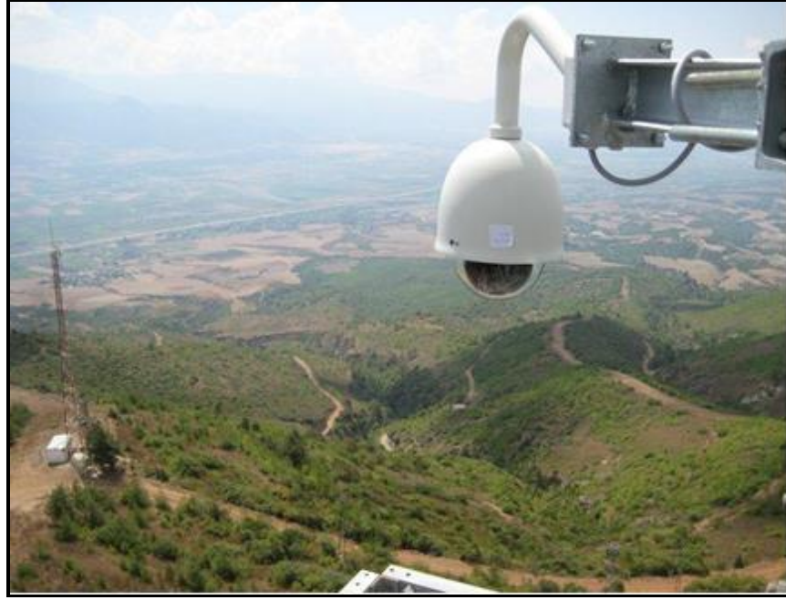
Fotoğraf 2.1 Yangın kulelerinin dijital yangın gözetleme sistemi
