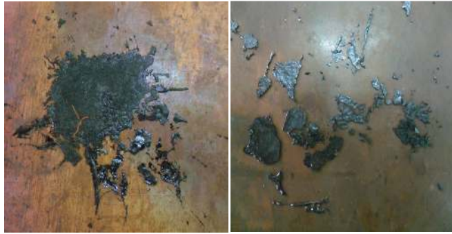
Resim 3.1. Ani soğutulmuş \text{Bi}_{1.8-x}\text{Ru}_x\text{Pb}_{0.2}\text{Sr}_2\text{CaCu}_2\text{O}_{10+\delta} cam yapısı
