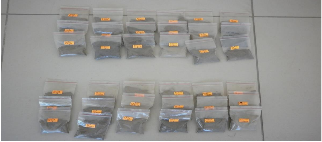
Fotoğraf 3.7. 2 mm'lik elekten geçirildikten sonra analiz için naylon poşetlere konulmuş toprak numuneleri
