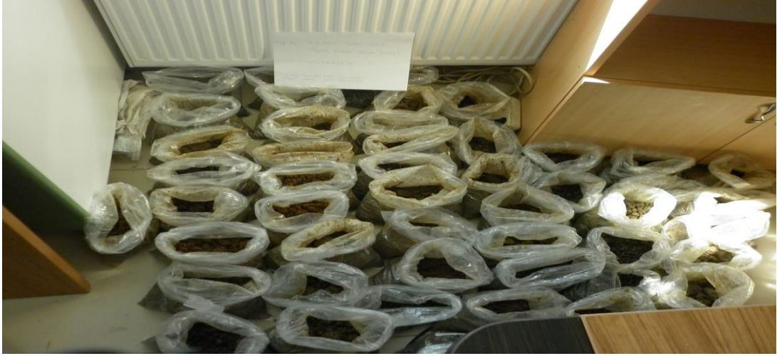
Fotoğraf 3.4. Araziden alınan bozulmuş toprak numunelerinin laboratuvarında ağızları açılarak kurumaya bırakılması
