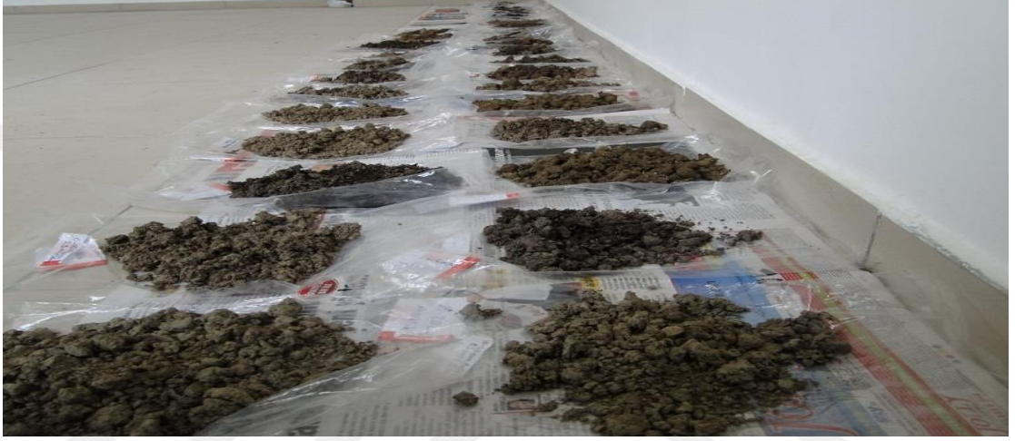
Fotoğraf 3.5. Araziden alınan toprak numunelerinin hava kurusu hale getirilmesi
