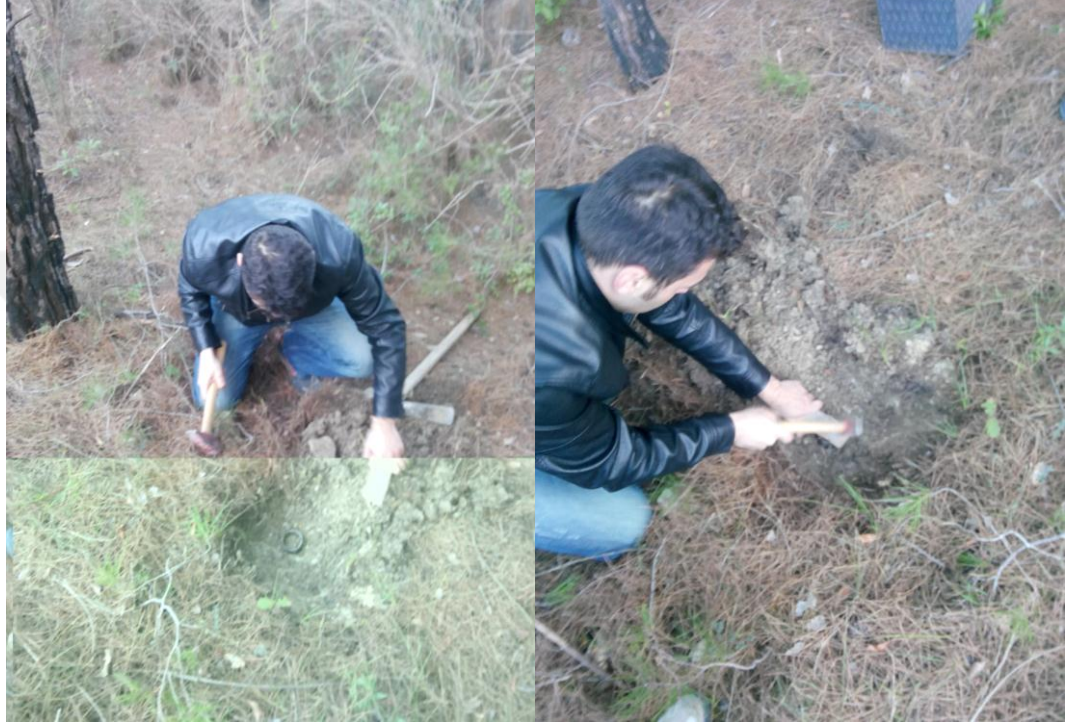
Fotoğraf 3.5. Deneme alanlarından alınan toprak silindir örnekleri alınımı
