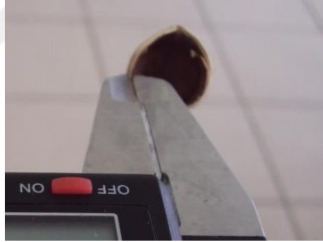
Fotoğraf 3.3. Dijital kumpas ile kabuk kalınlığı ölçümü (İslam, 2000).
