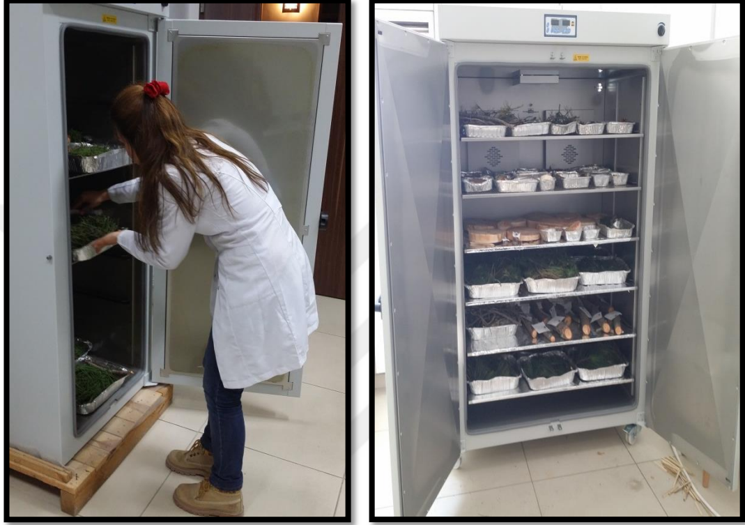
Fotoğraf 3.5. Fırın kurusu ağırlıkların belirlenmesi
